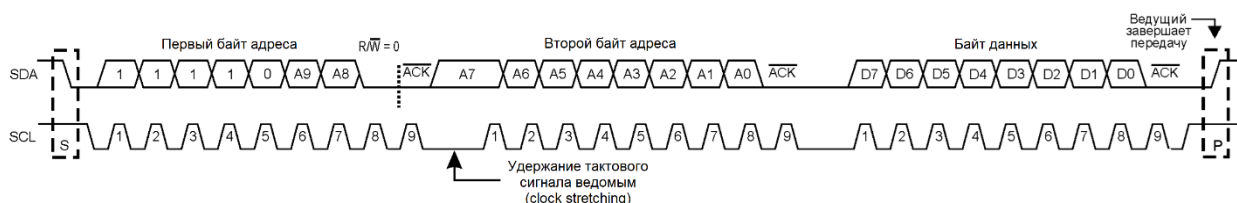
Рисунок 62 – Передача по I2C в 10-битном режиме
