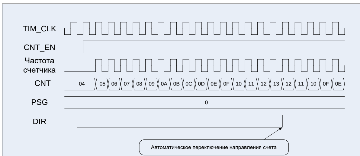
Рисунок 32 – Диаграммы работы таймера, счет двунаправленный, сначала прямой
