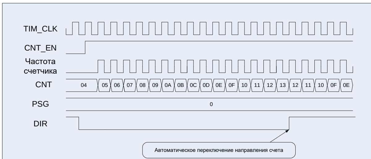
Рисунок 32 – Диаграммы работы таймера, счет двунаправленный, сначала прямой
