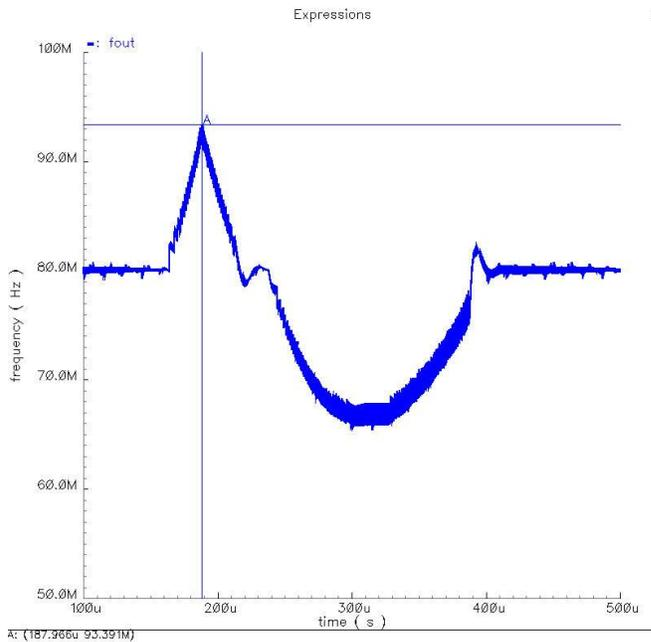
Характер изменения выходной частоты PLL (80 МГц = 10 МГц • 8) при резком изменении напряжения питания
