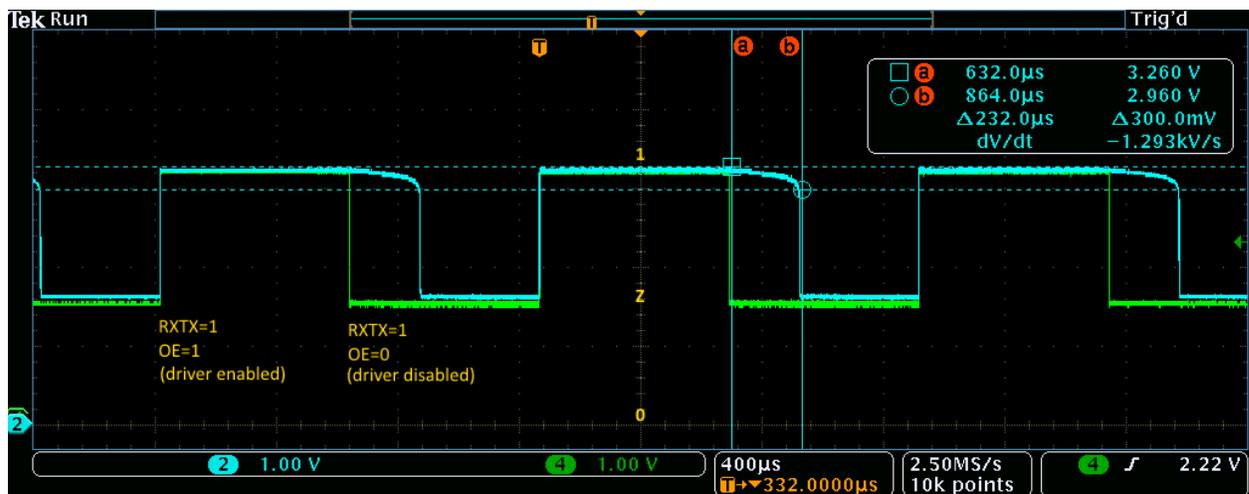
Канал 4 (Зеленый) – нагрузка 1 кОм (ожидаемое поведение с высокоомной нагрузкой)
