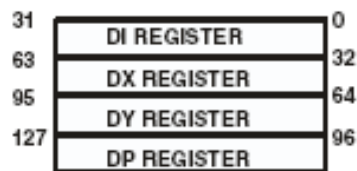
Рисунок 49 – Регистры блока управления передачей DMA
