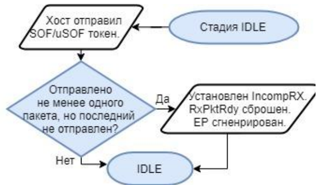
Рисунок 124 – Передача транзакций OUT
