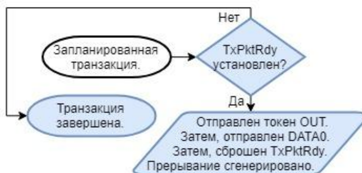
Рисунок 133 – Передача транзакций OUT
