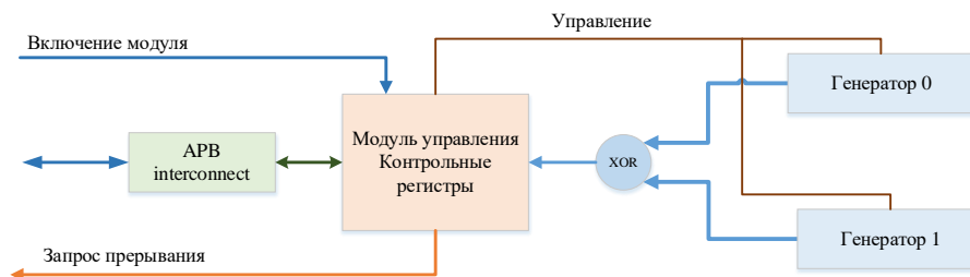
Рисунок 112 – Структурная схема блока генератора случайных чисел
