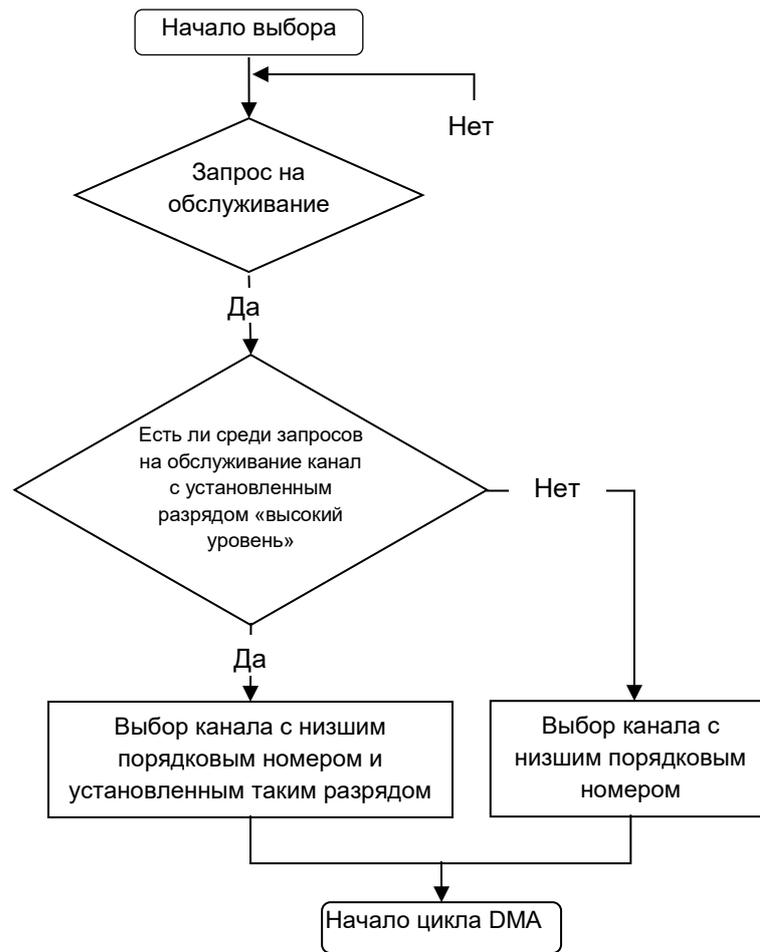
Рисунок 92 – Алгоритм выбора следующего канала для обслуживания
