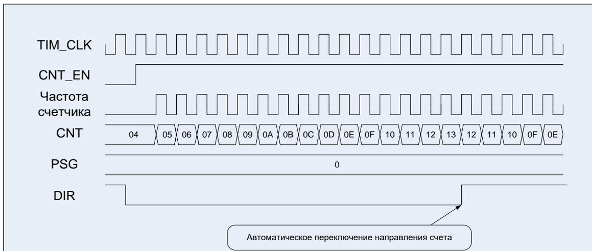
Рисунок 35 – Диаграммы работы таймера, счет двунаправленный, сначала прямой
