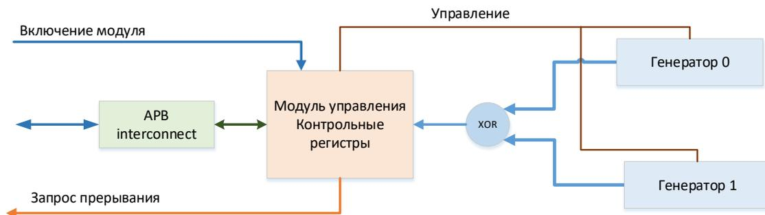
Рисунок 103 – Структурная схема блока генератора случайных чисел
