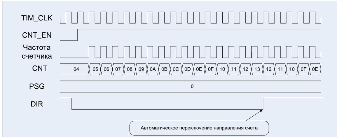
Рисунок 65 – Диаграммы работы таймера, счет вверх/вниз, сначала вверх
