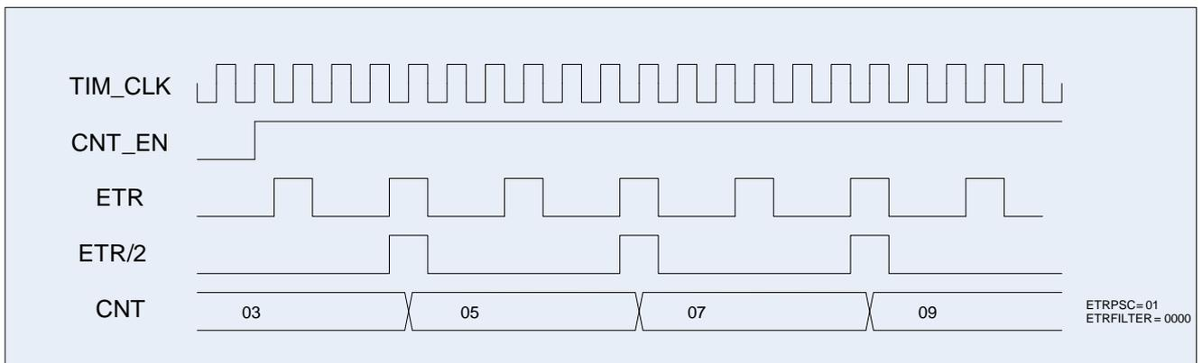
Рисунок 77 – Диаграмма тактирования сигналом со входа ETR
