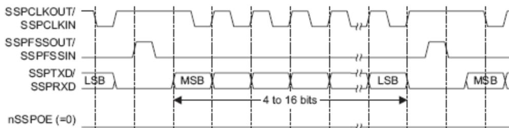
Рисунок 103 – Формат синхронного обмена протокола SPI, SPO=1, SPH=0
