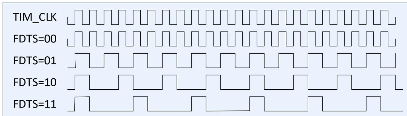
Рисунок 73 – Диаграммы возможных частот семплирования данных (FDTS)
