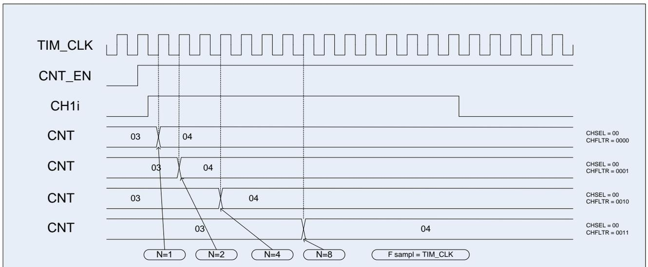
Рисунок 75 – Диаграмма внешнего тактирования с разными вариантами фильтра
