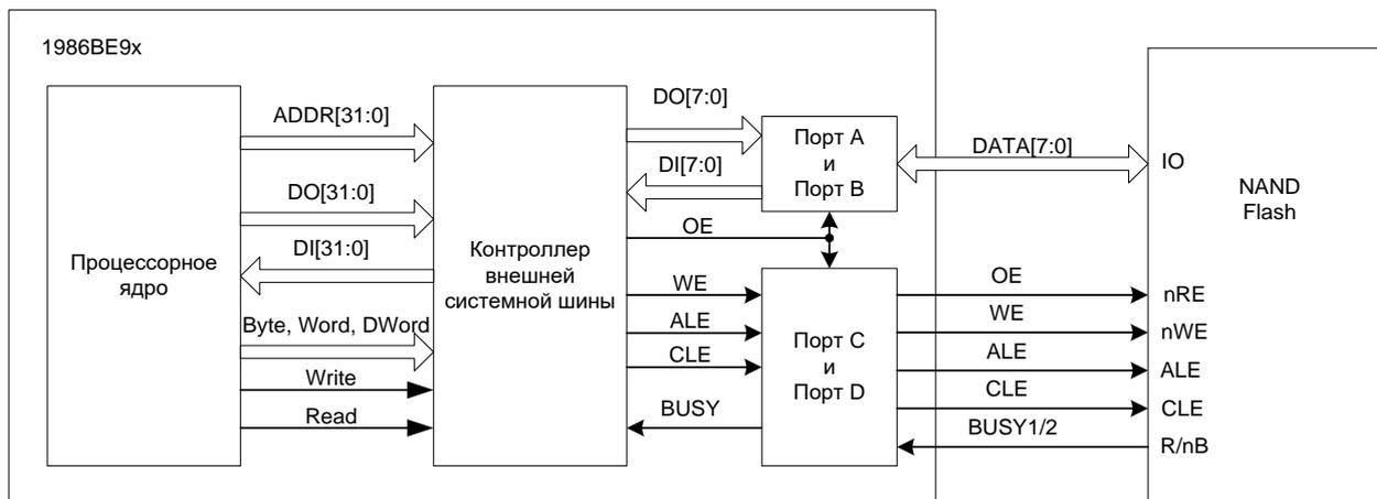
Рисунок 39 – Подключение внешней NAND Flash
