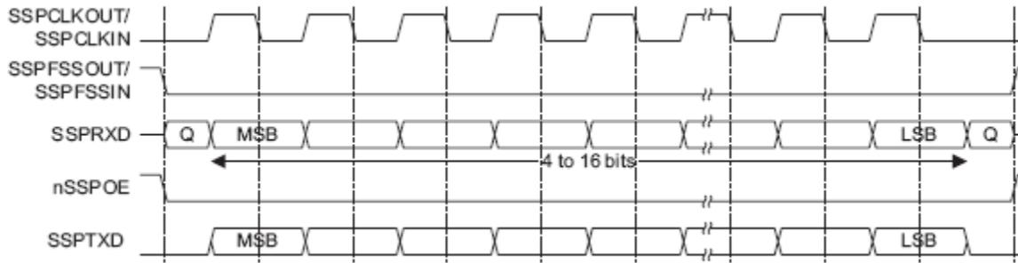
Рисунок 101 – Формат синхронного обмена протокола SPI, SPO=0, SPH=1
