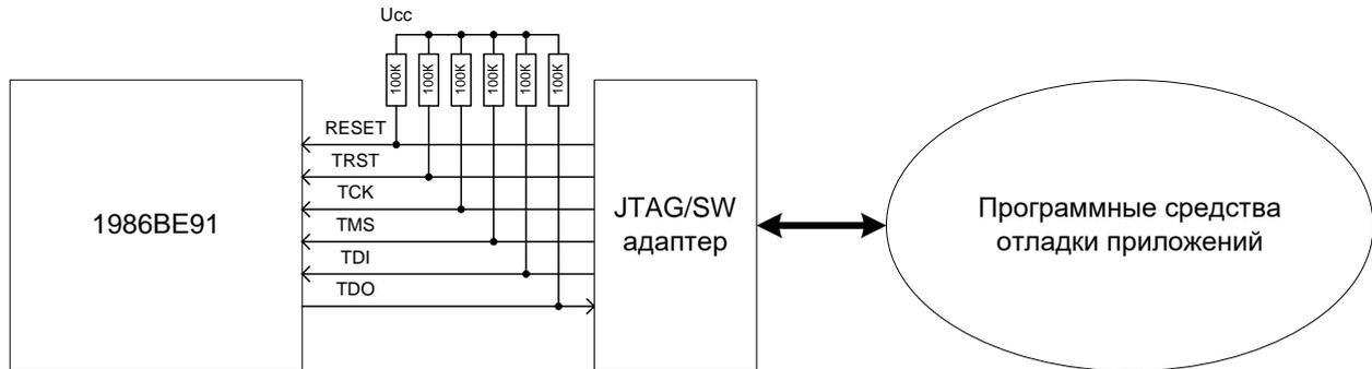
Рисунок 13 – Схема работы в режиме отладки
