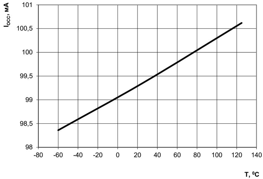
Рисунок 132 – Зависимость динамического тока потребления от температуры при:  $f_c = 80$  МГц
