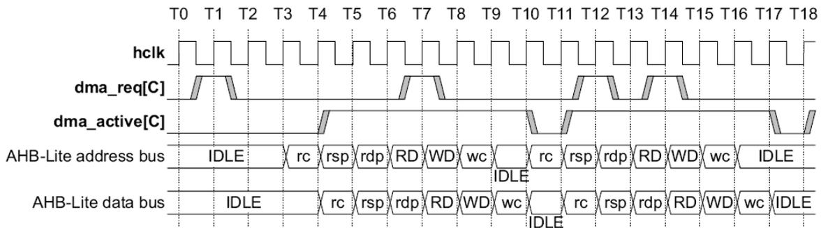
Рисунок 120 – Диаграмма работы при получении импульсного запроса
