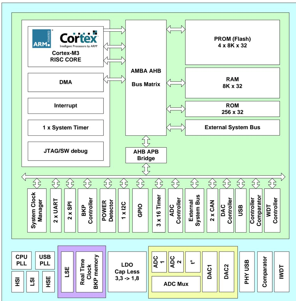
Рисунок 1 – Структурная блок-схема микроконтроллера 1986BE9ху
