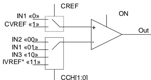
\*IVREF – выход внутреннего источника опорного напряжения 1,2 В.
