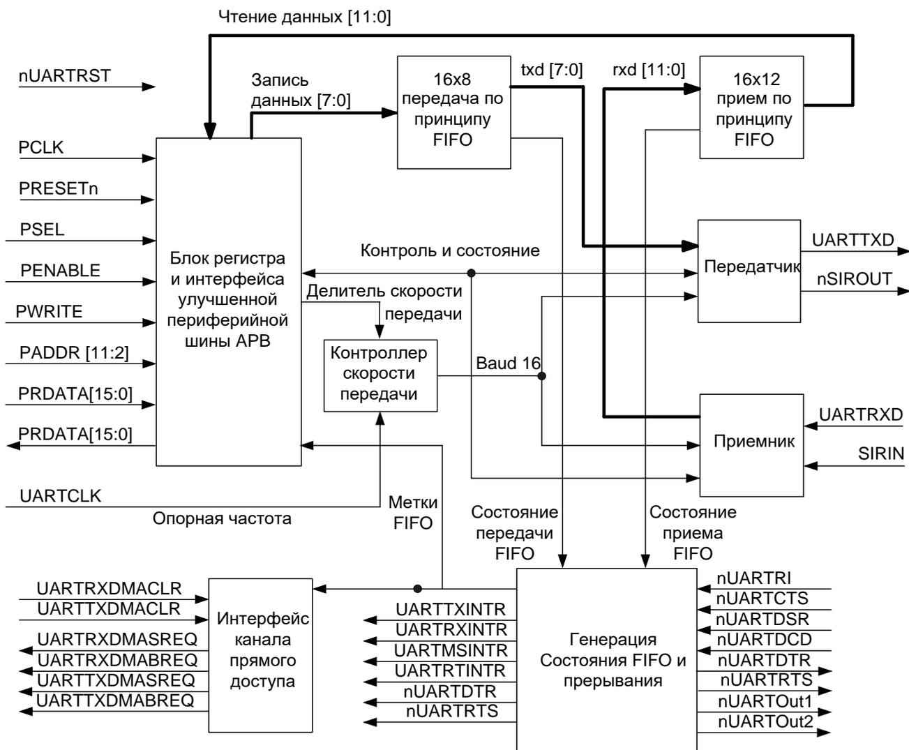
Рисунок 112 – Блок-схема универсального асинхронного приёмопередатчика (UART)
