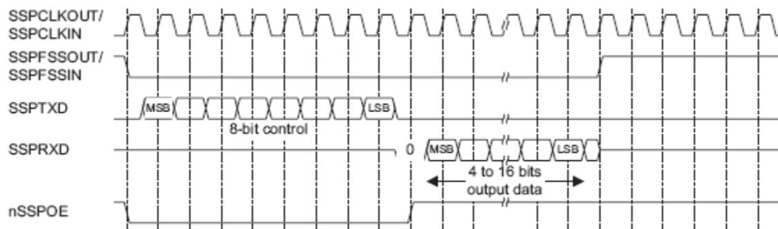
Рисунок 105 – Формат синхронного обмена протокола Microwire (одиночный обмен)
