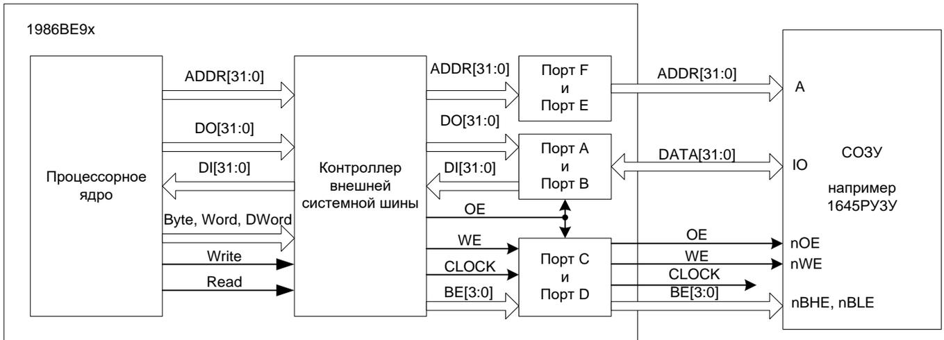
**Рисунок 36 – Обмен по внешней системной шине при задании длительности через биты WAIT\_STATE**
