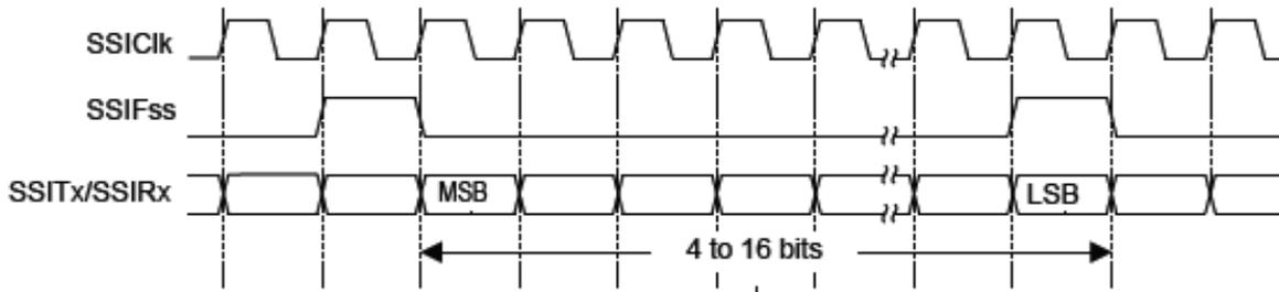
Рисунок 98 – Формат синхронного обмена протокола SSI (непрерывный обмен)
