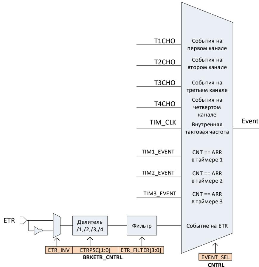
Рисунок 76 – Схема тактирования сигналом со входа ETR
