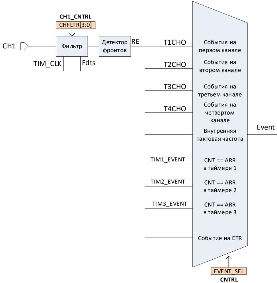
Рисунок 74 – Тактирование с входа первого канала
