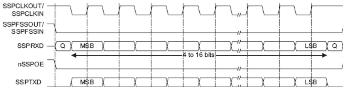
Рисунок 104 – Формат синхронного обмена протокола SPI, SPO=1, SPH=1
