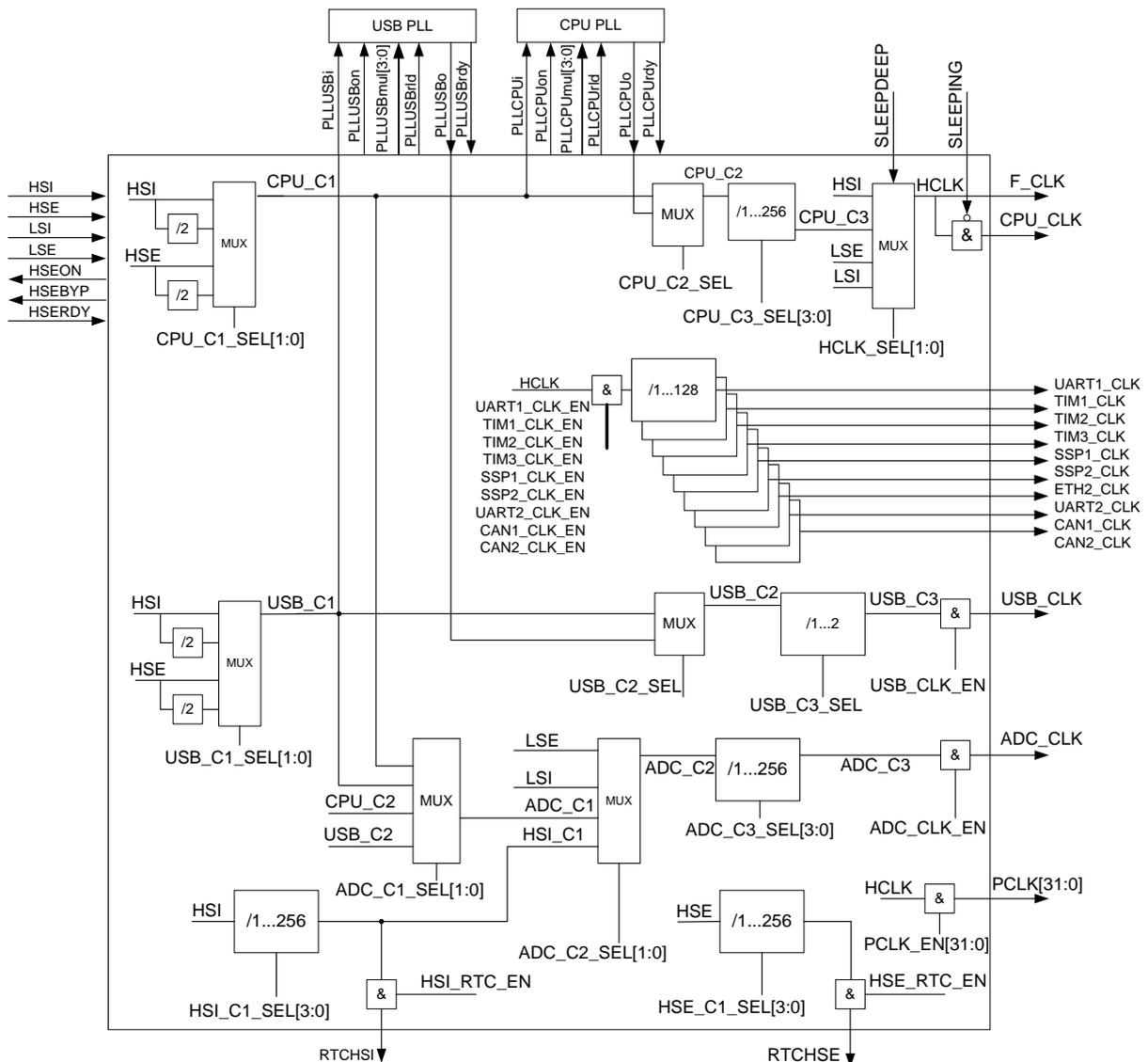
Рисунок 27 – Структурная блок-схема формирования тактовой частоты
