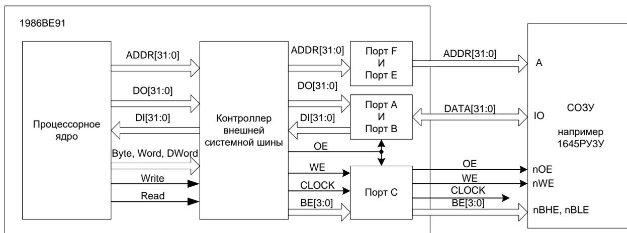
Рисунок 32 – Обмен по внешней системной шине
