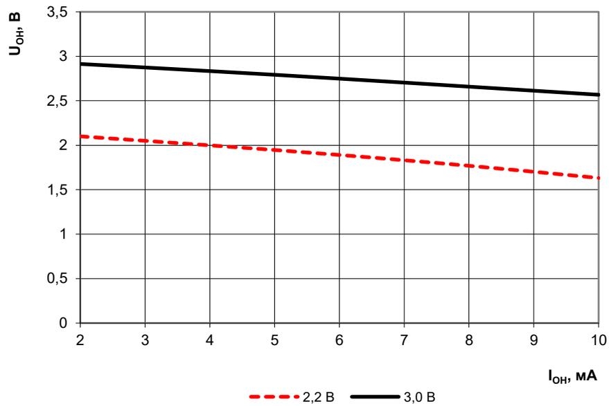
Рисунок 137 – Зависимость выходного напряжения высокого уровня от выходного тока высокого уровня при напряжении питания 2,2 и 3,0 В
