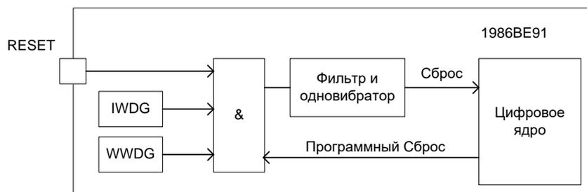
Рисунок 7 – Структурная блок-схема сброса
