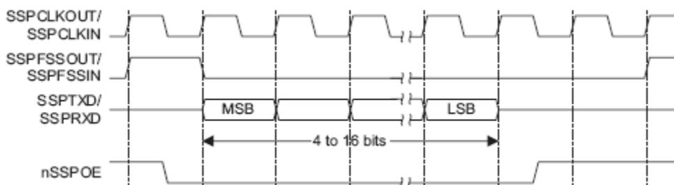
Рисунок 97 – Формат синхронного обмена протокола SSI (единичный обмен)
