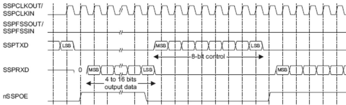
Рисунок 106 – Формат синхронного обмена протокола Microwire (непрерывный обмен)
