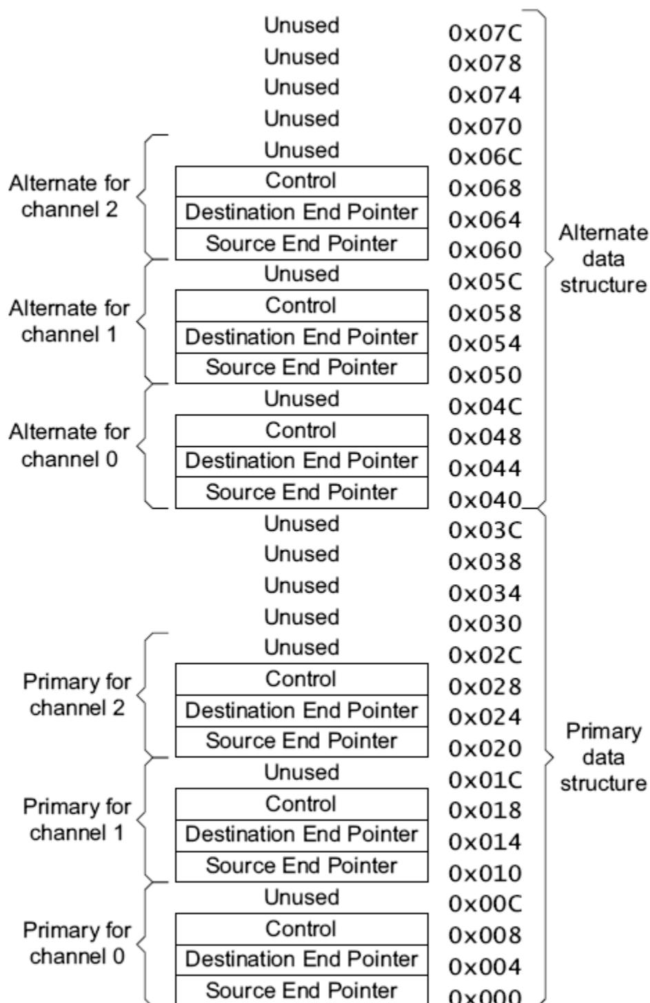
Рисунок 130 – Карта памяти для трех каналов DMA, включая альтернативную структуру
