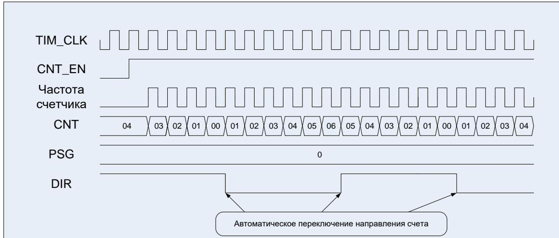
Рисунок 70 – Диаграммы работы счетчика: счет вниз/вверх
