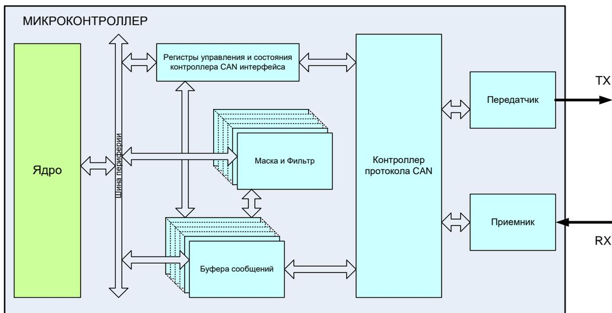
**Рисунок 53 – Структурная блок-схема контроллера CAN**
