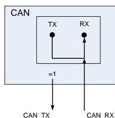
Рисунок 46 – Режим работы только на прием - Receive Only Mode
