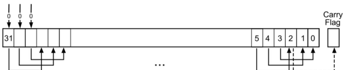
Рисунок 22 – Инструкция  $LSR \# 3$
