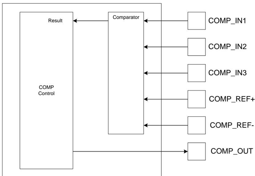
Рисунок 92 – Структура блока компаратора
