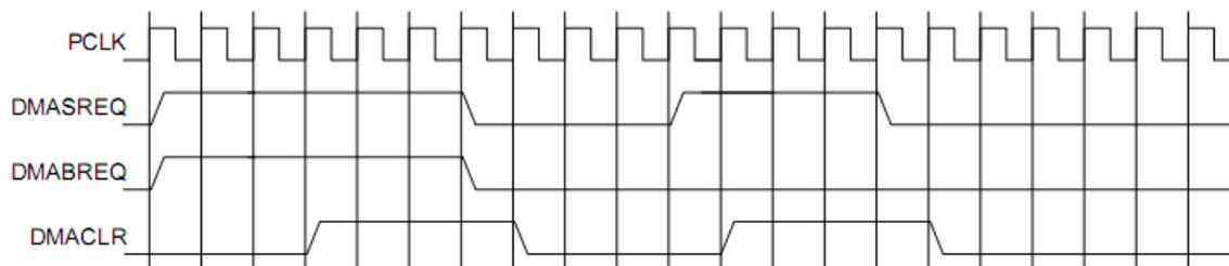
Рисунок 118 – Временные диаграммы одноэлементного и блочного запросов DMA
