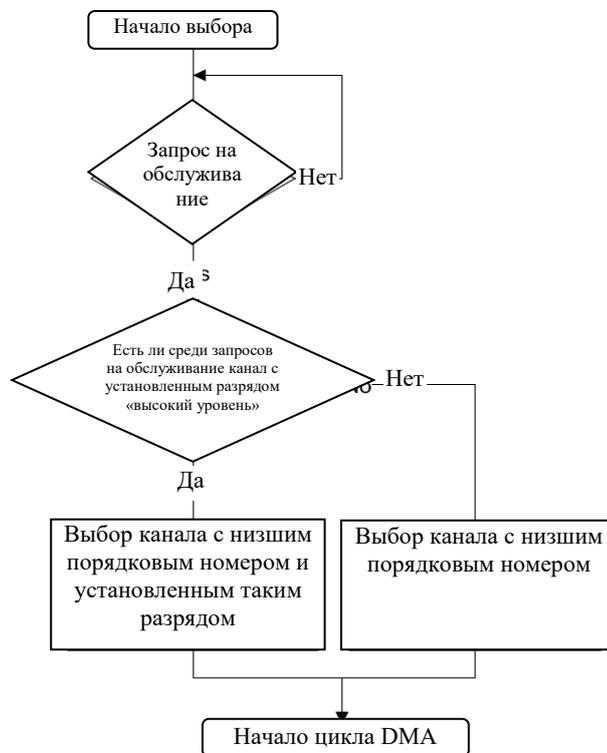
Рисунок 125 – Алгоритм выбора следующего канала для обслуживания
