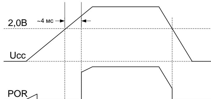
Рисунок 6 – Сигнал сброса при включении и выключении основного напряжения питания
