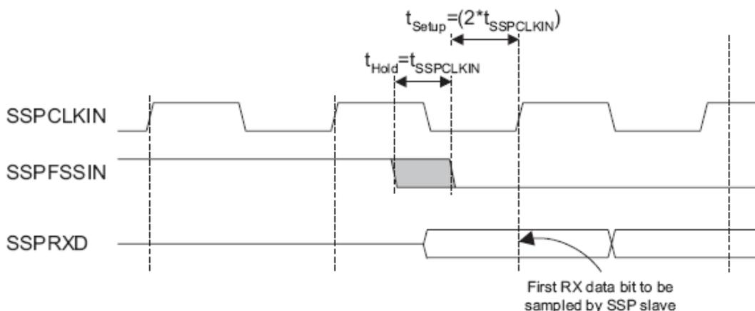
Рисунок 107 – Формат Microwire, требования к времени установки и удержания сигнала
