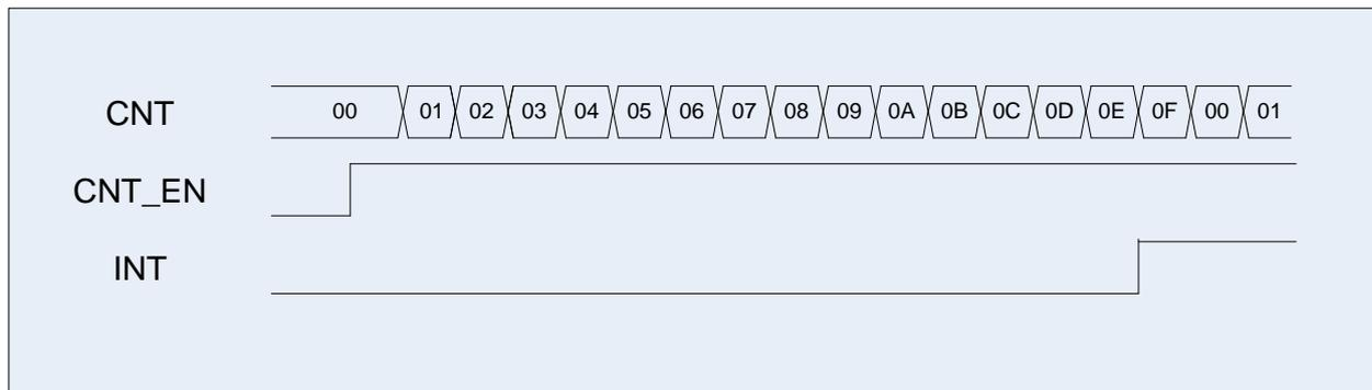
Рисунок 86 – Режим обычного счетчика
