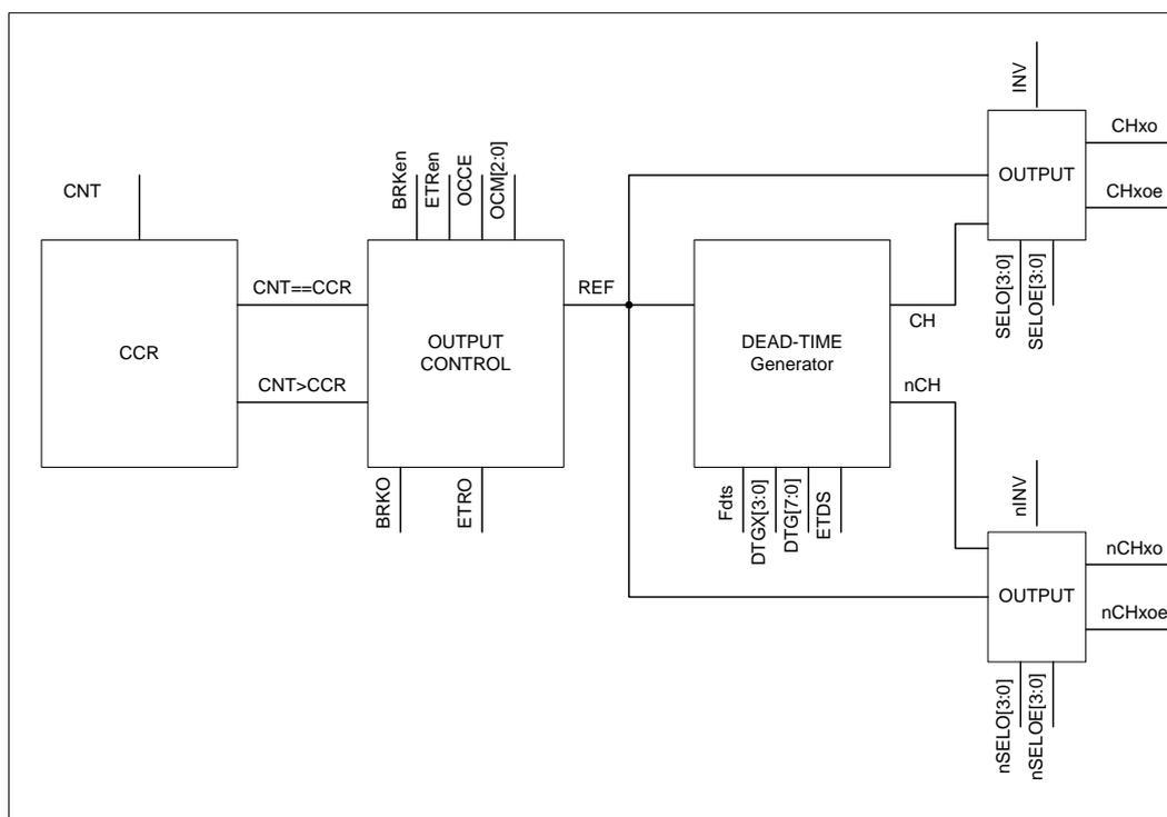
**Рисунок 80 – Структурная схема блока формирования ШИМ**
