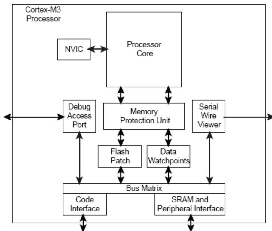
Рисунок 19 – Структурная блок-схема процессорного ядра Cortex-M3
