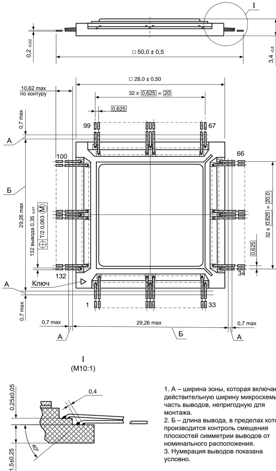
1. А – ширина зоны, которая включает действительную ширину микросхемы и часть выводов, непригодную для монтажа.
