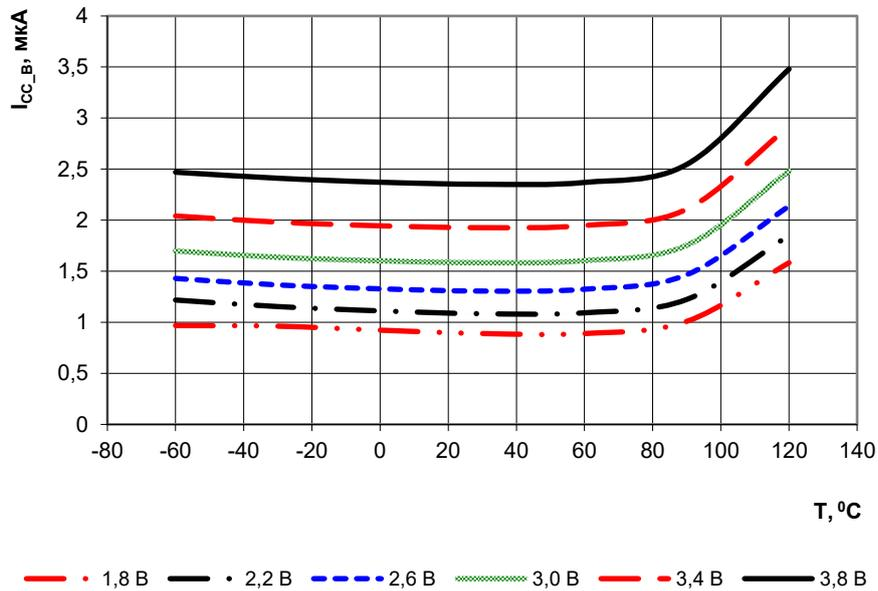
Рисунок 135 – Зависимость тока потребления батарейного домена от температуры при разном напряжении
