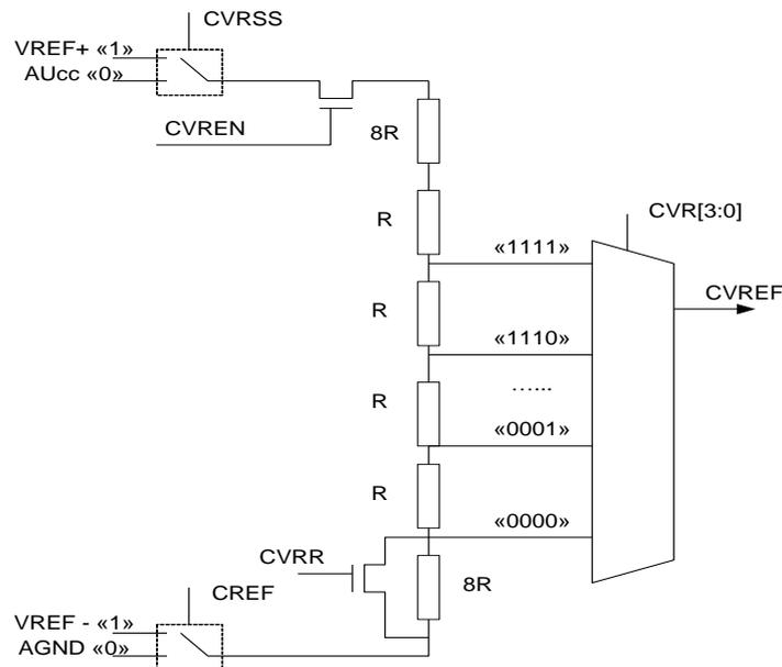
Рисунок 94 – Структура блока формирования CVREF
