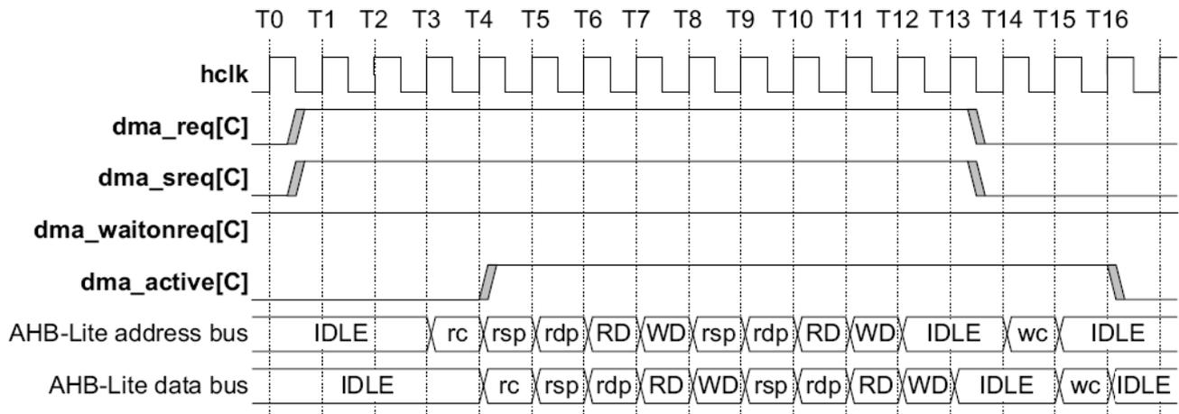
Рисунок 123 – Диаграмма работы контроллера DMA при использовании dma\_waitonreq
