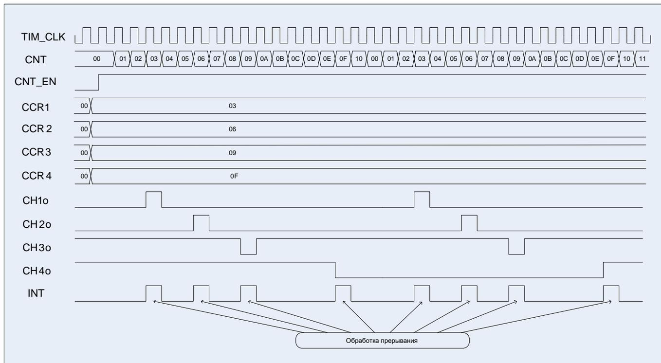
Рисунок 88 – Диаграммы примера работы в режиме ШИМ
