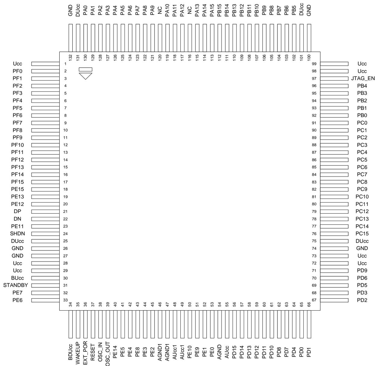
Рисунок 2 – Расположение выводов в 132-х выводном корпусе 4229.132-3
