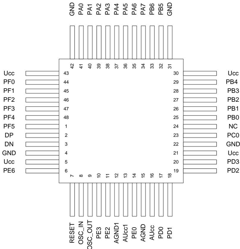
**Рисунок 4 – Расположение выводов в 48-ми выводном корпусе N16.48-1B**
