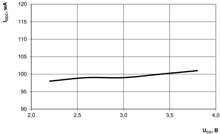
Рисунок 133 – Зависимость динамического тока потребления от напряжения питания
