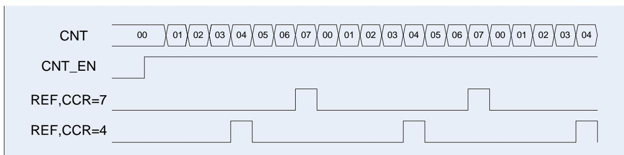
Рисунок 81 – Диаграмма работы схемы в режиме ШИМ, CCR1\_EN=0
