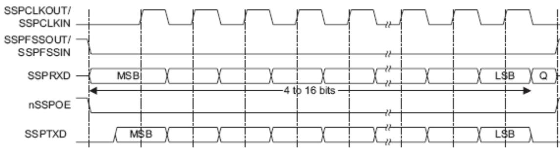
Рисунок 99 – Формат синхронного обмена протокола SPI, SPO=0, SPH=0
