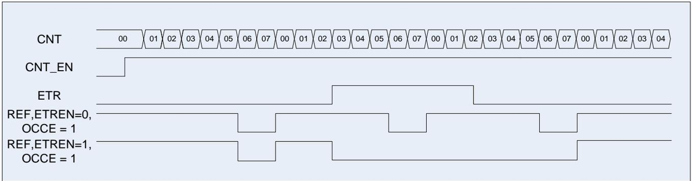
Рисунок 83 – Диаграмма работы схемы в режиме ШИМ, CCR1\_EN = 0
