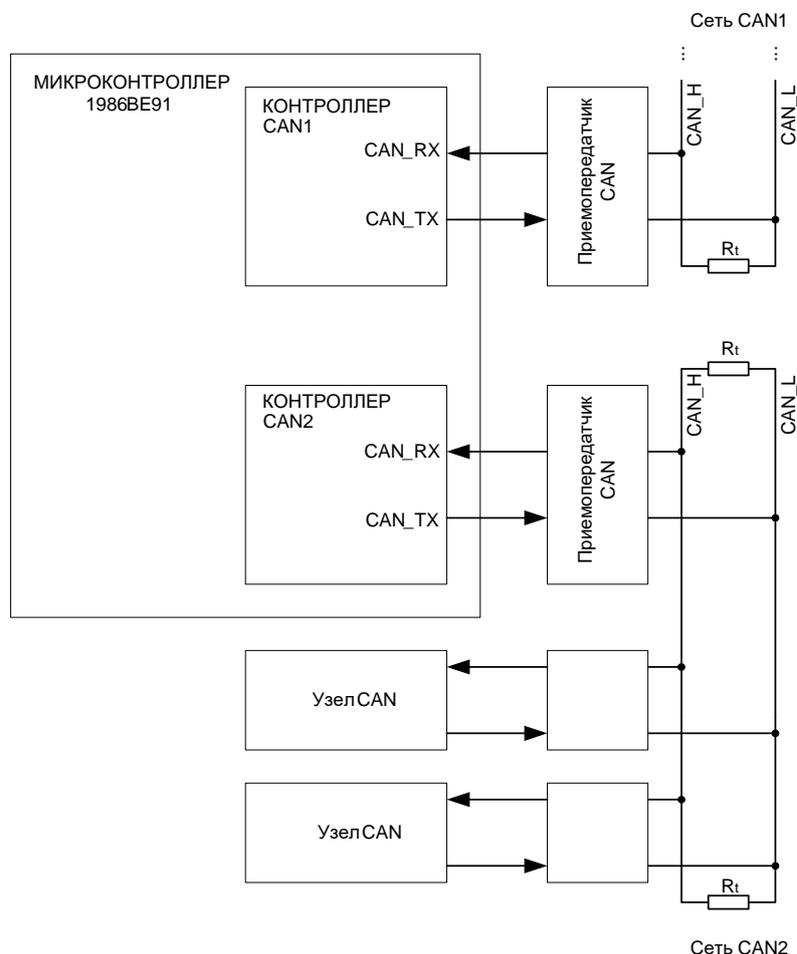
Рисунок 44 – Структурная блок – схема организации сети CAN
