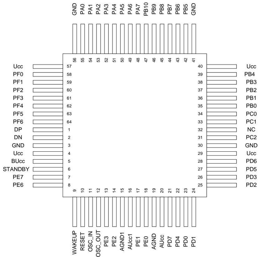
**Рисунок 3 – Расположение выводов в 64-х выводном корпусе N18.64-1B**
