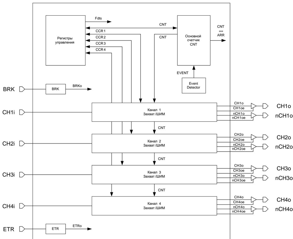
Рисунок 62 – Структурная схема блока Таймер
