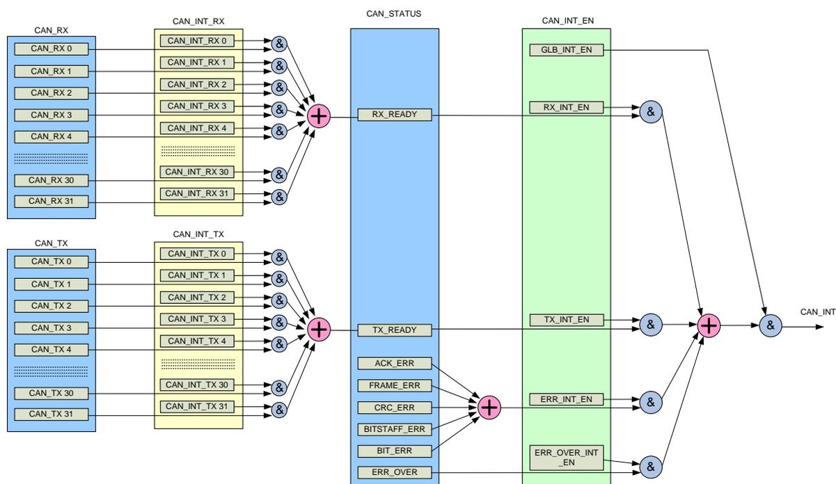
Рисунок 61 – Схема формирования прерывания блока CAN
