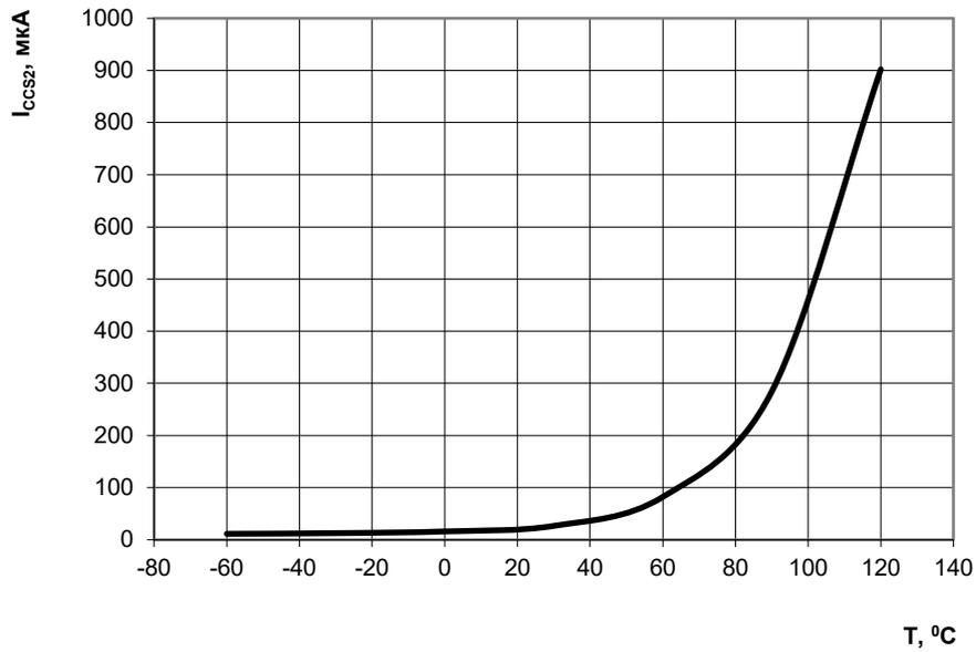
Рисунок 136 – Зависимость статического тока потребления в режиме покоя (регулятор напряжения включен) от температуры
