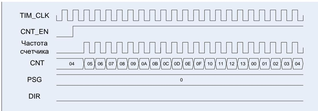
Рисунок 63 – Диаграммы работы таймера, счет вверх
