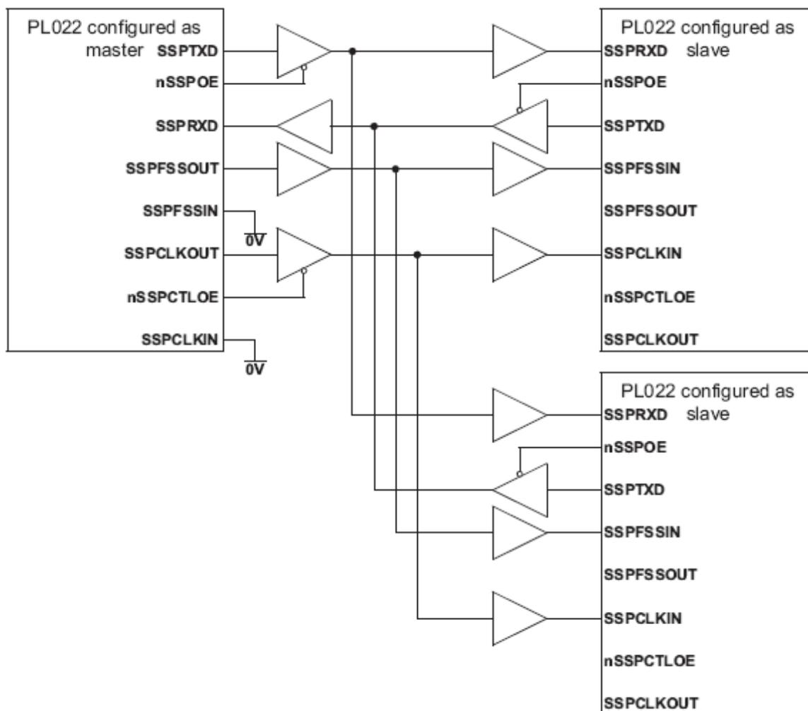
Рисунок 108 – Ведущее устройство SSP подключено к двум ведомым
