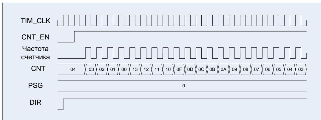
Рисунок 64 – Диаграммы работы таймера, счет вниз
