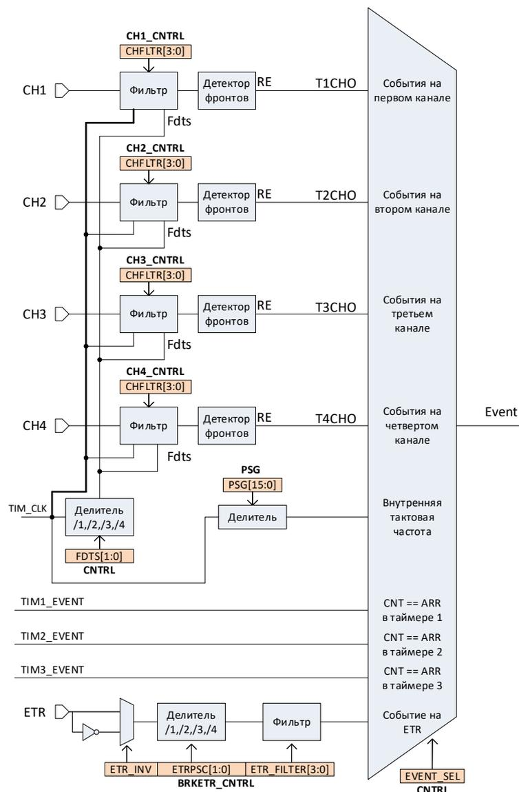
Рисунок 67 – Структурная схема формирования события для счета
