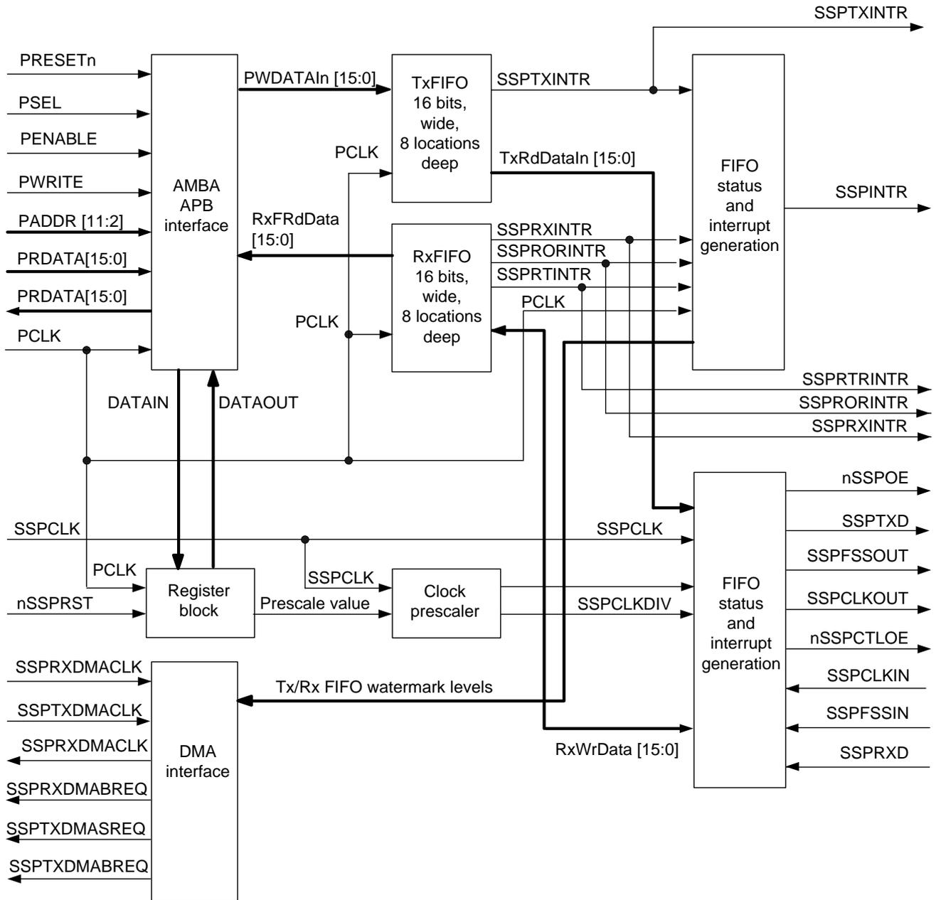
Рисунок 96 – Структурная схема модуля SSP
