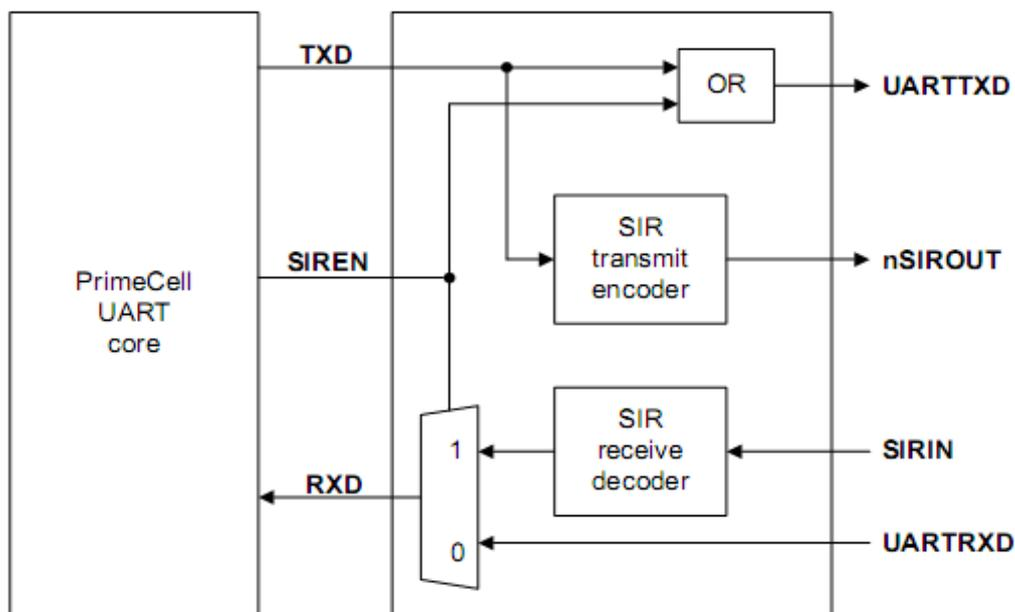
Рисунок 113 – Структурная схема кодека IrDA
