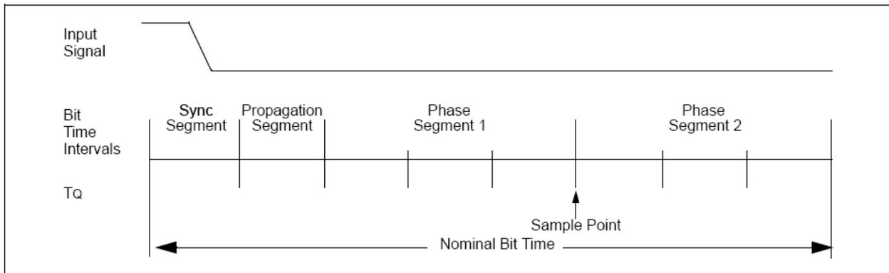
Рисунок 54 – Структура битового интервала
