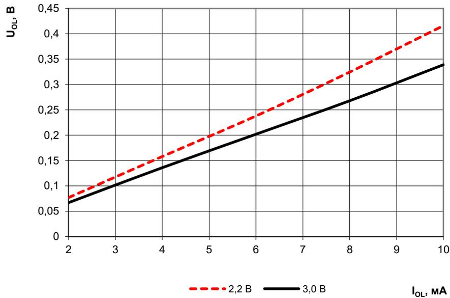
Рисунок 138 – Зависимость выходного напряжения низкого уровня от выходного тока низкого уровня при напряжении питания 2,2 и 3,0 В
