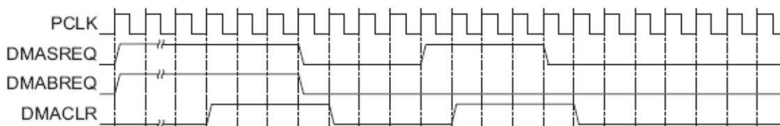
Рисунок 111 – Временные диаграммы обмена в режиме DMA
