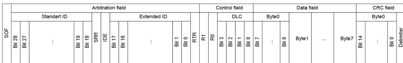
**Рисунок 51 – Структура расширенного пакета данных**
