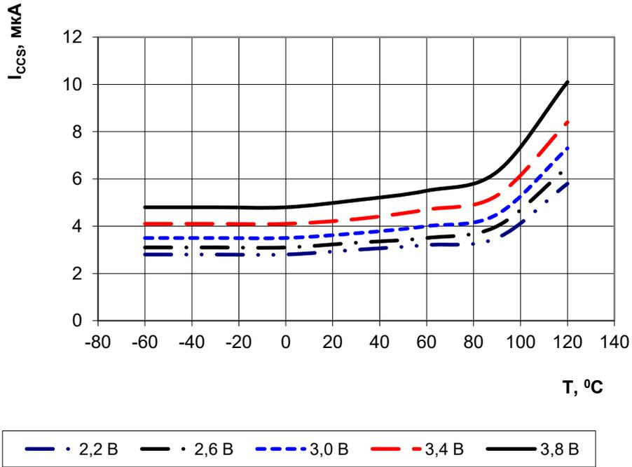
Рисунок 134 – Зависимость статического тока потребления в режиме покоя (регулятор напряжения выключен) от температуры при разном напряжении
