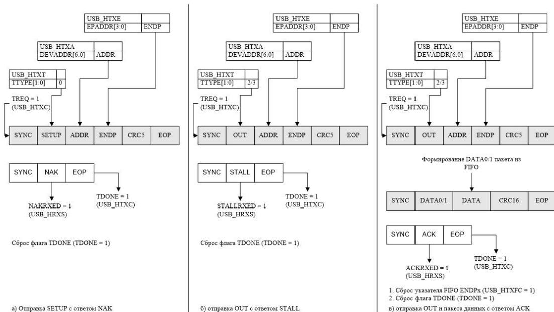
Рисунок 42 (а, б, в) – Транзакция SETUP/OUT (USB Host)
