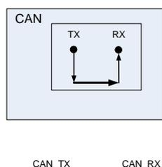
Рисунок 47 – Режим самотестирования - Self Test Mode
