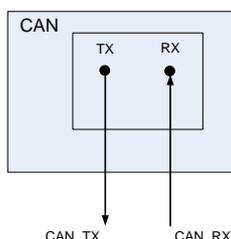
Рисунок 45 – Режим нормальной передачи
