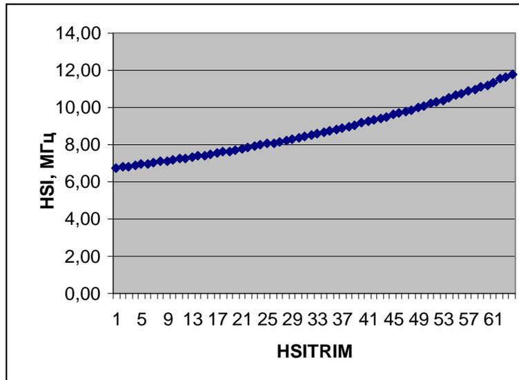
Рисунок 30 – Зависимость частоты HSI от значения HSITRIM
