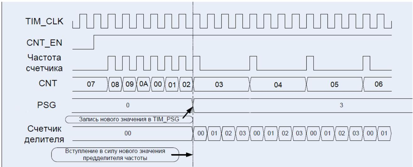
Рисунок 68 – Диаграммы работы счетчика: счет вверх
