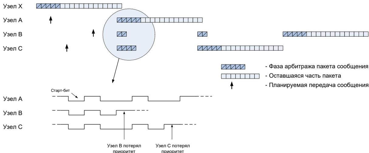
**Рисунок 52 – Арбитраж на шине CAN**
