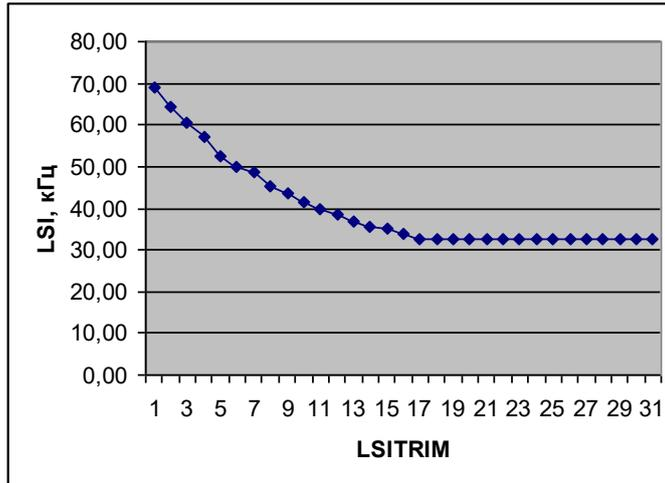
Рисунок 29 – Зависимость частоты LSI от значения LSITRIM
