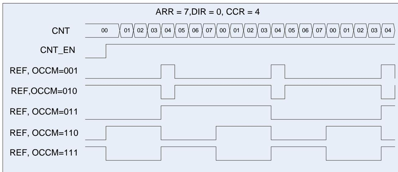
Рисунок 82 – Диаграмма работы схемы в режиме ШИМ, CCR1\_EN = 0
