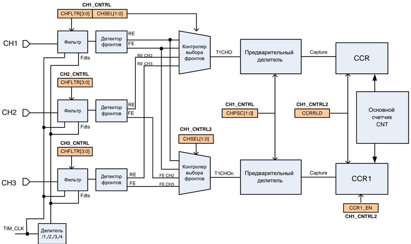
**Рисунок 78 – Структурная схема блока захвата на примере канала 1**
