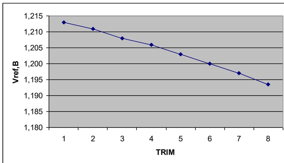
Рисунок 90 – Зависимость источника опорного напряжения от подстройки
