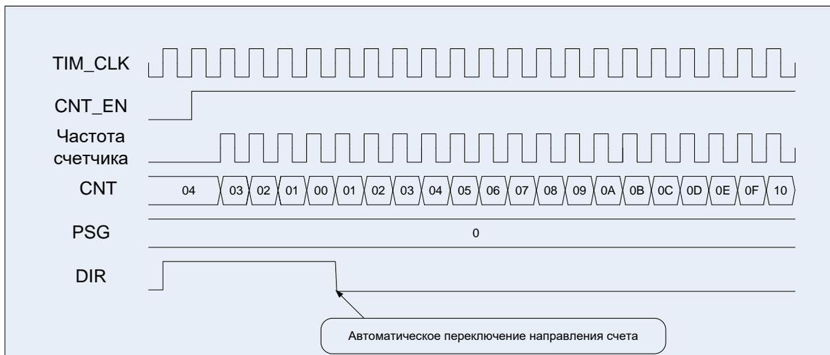
Рисунок 66 – Диаграммы работы таймера, счет вверх/вниз, сначала вниз
