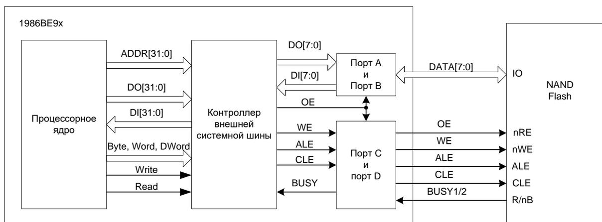
Рисунок 35 – Подключение внешней NAND Flash
