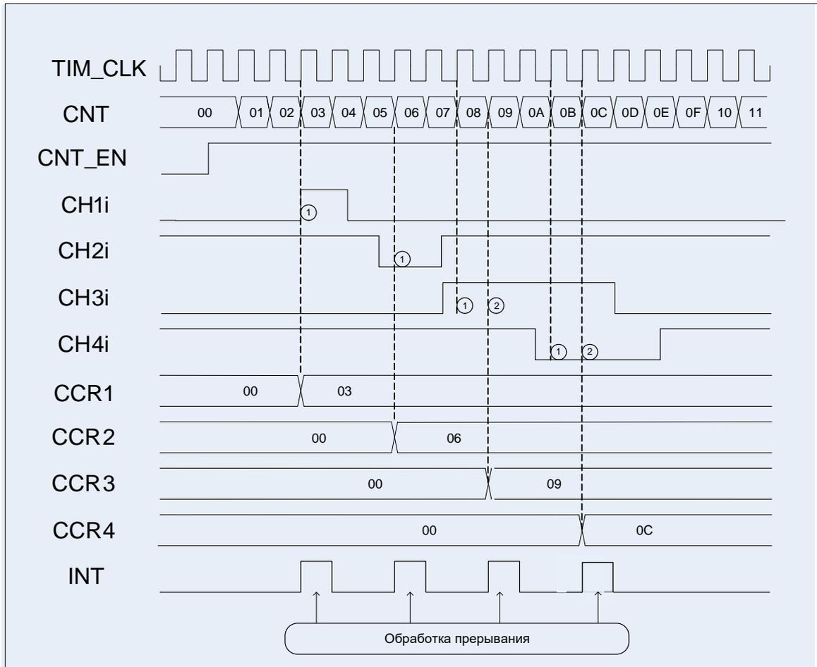
Рисунок 87 – Диаграммы примера работы в режиме захвата
