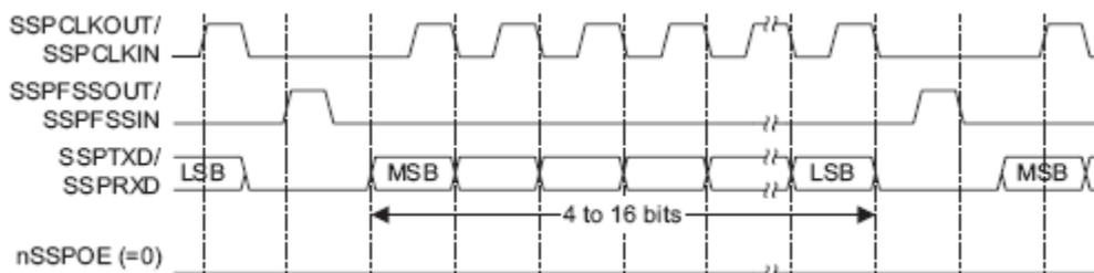
Рисунок 100 – Формат синхронного обмена протокола SPI, SPO=0, SPH=0
