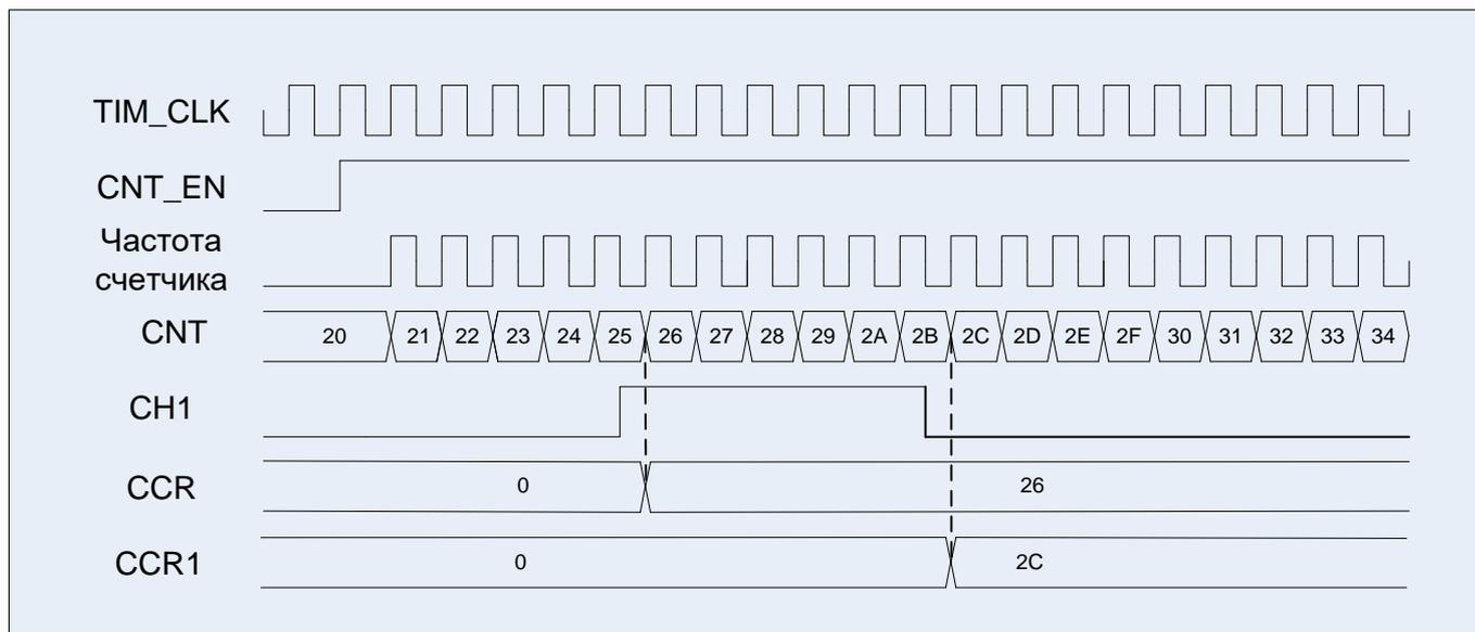
**Рисунок 79 – Диаграмма захвата события со входа первого канала**
