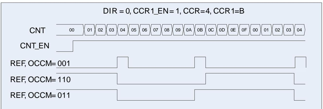
Рисунок 85 – Диаграмма работы схемы в режиме ШИМ, CCR1\_EN = 1
