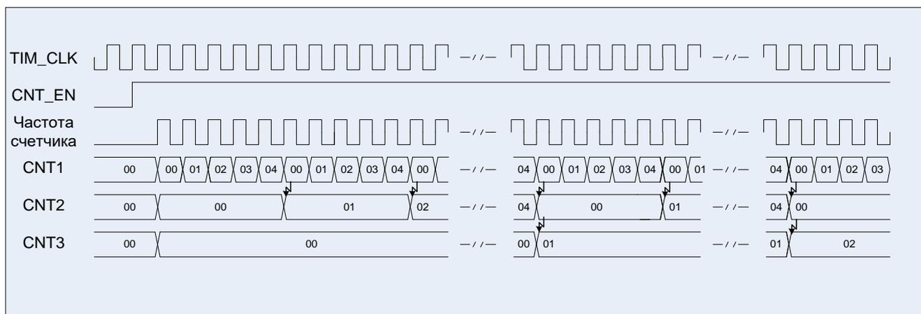
Рисунок 72 – Диаграммы работы трех таймеров в каскаде
