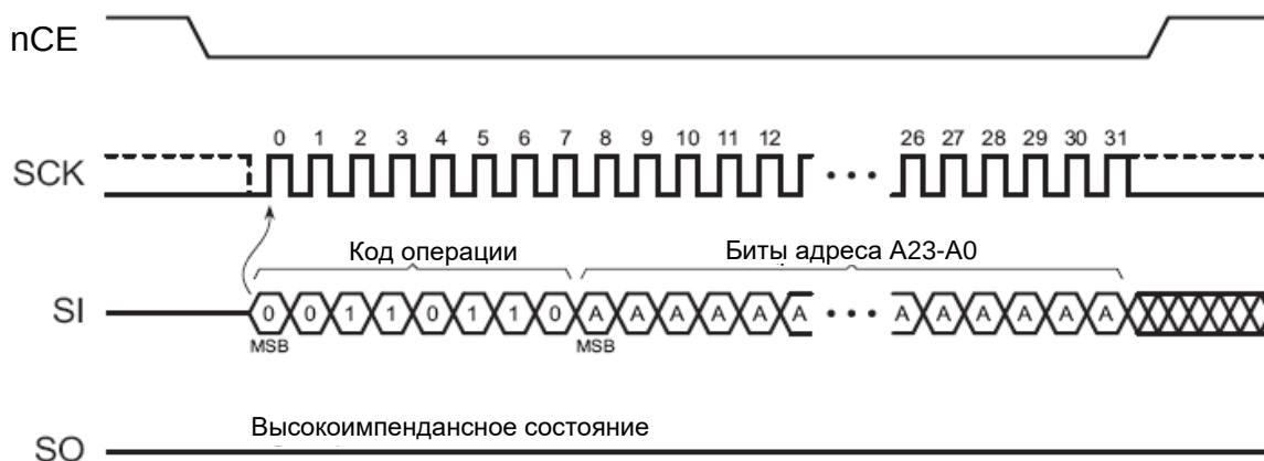
Рисунок 21 – Операция установки защиты сектора
