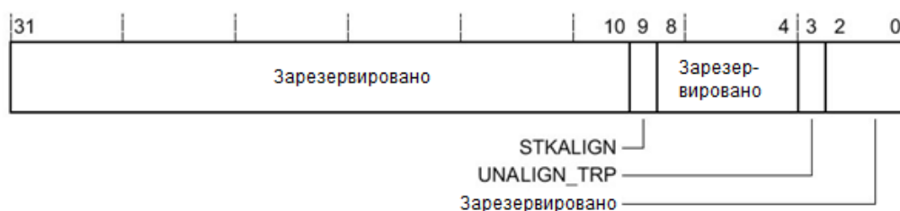
Рисунок 111 – Назначение разрядов регистра CCR
