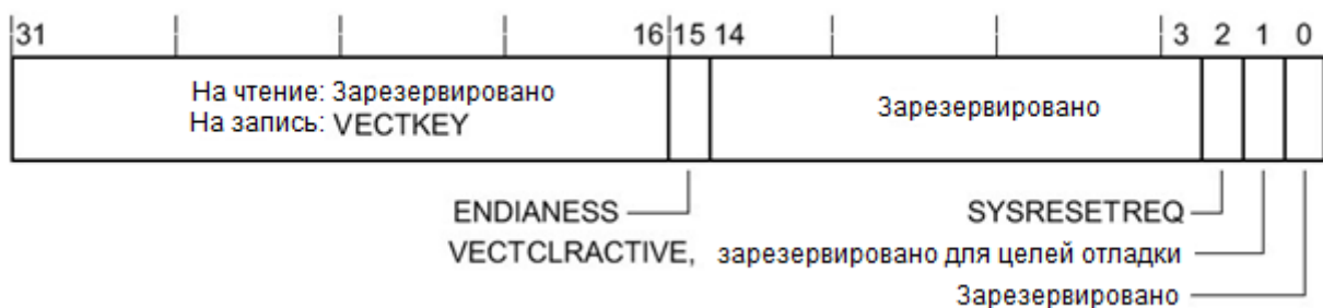
Рисунок 109 – Назначение разрядов регистра AIRCR
