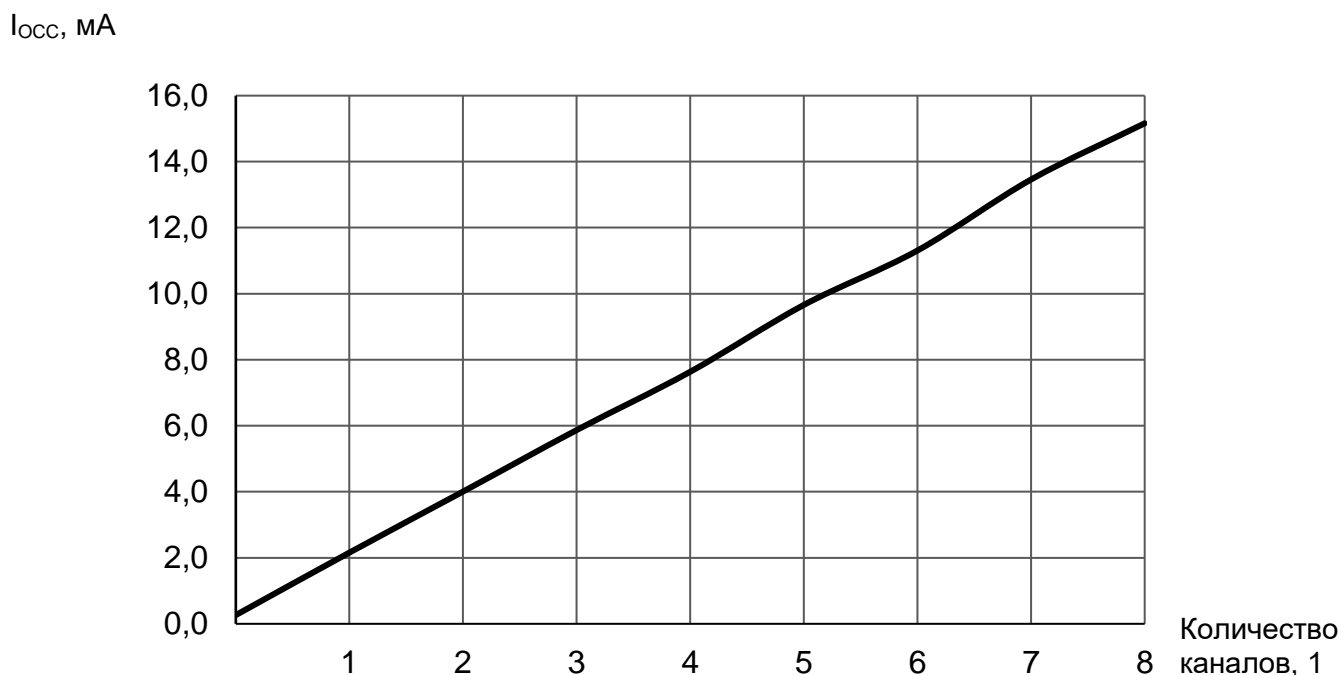
Рисунок 23 – Зависимость динамического тока потребления от количества включенных каналов в режиме преобразования тока (MDS=001), при f_c = 4 МГц, U_{REF} = 2,4 В при U_{CC} = 3,6 В, U_{IH} = 3,6 В, U_{IL} = 0 В, T = 25 °С
