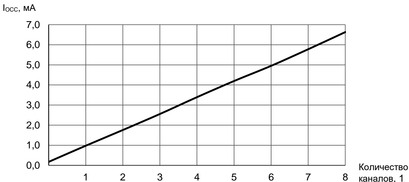
Рисунок 22 – Зависимость динамического тока потребления от количества включенных каналов в режиме преобразования напряжения (MDS=010), при f_c = 4 МГц, внешним опорным напряжением U_{REF} = 2,4 В при U_{CC} = 3,6 В, U_{IH} = 3,6 В, U_{IL} = 0 В, T = 25 °С
