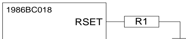
Рисунок 36 – Типовая схема включения резистора RSET
