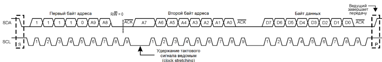
Рисунок 97 – Передача по I2C в 10-битном режиме
