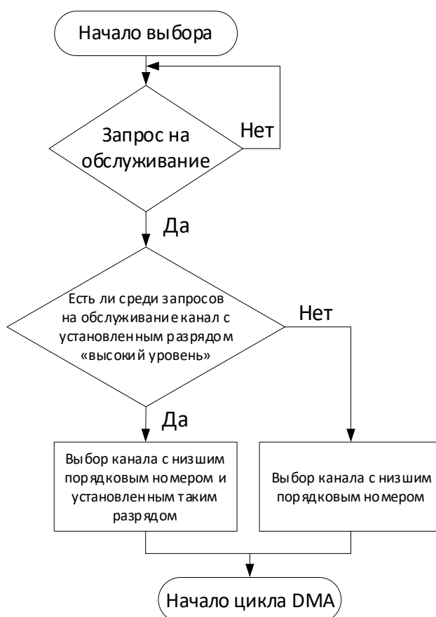
Рисунок 127 – Алгоритм выбора следующего канала для обслуживания
