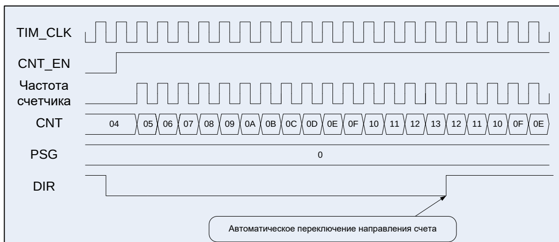
Рисунок 22 – Диаграммы работы таймера, счет двунаправленный, сначала прямой
