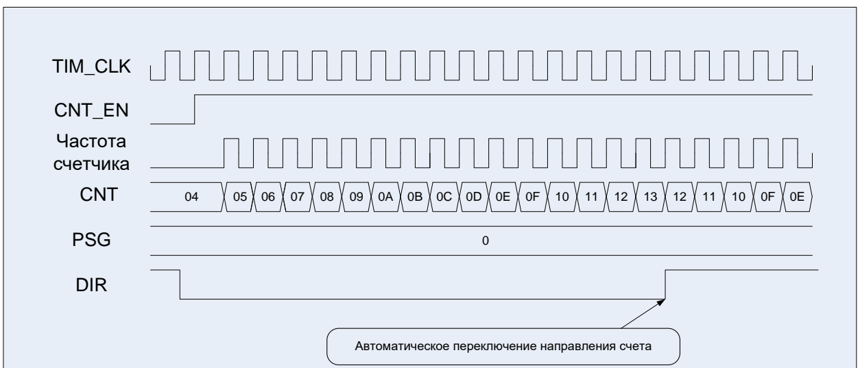
Рисунок 49 – Диаграммы работы таймера, счет вверх/вниз, сначала вверх
