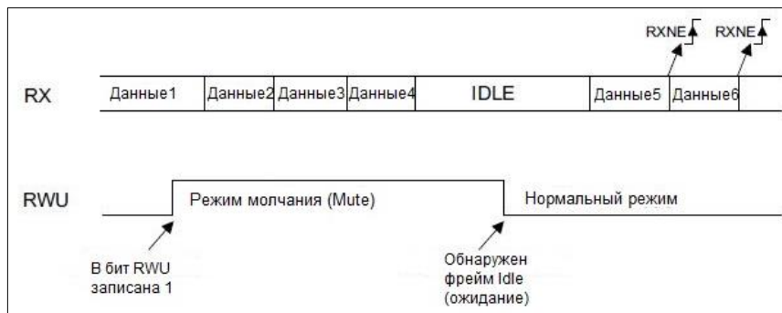
Рисунок 120 – Режим молчания (Mute) с обнаружением линии Idle
