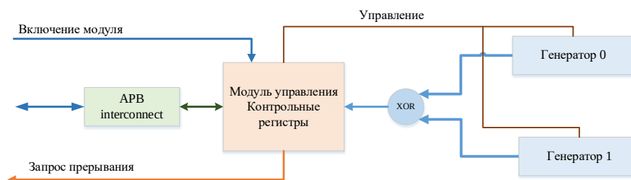
Рисунок 112 – Структурная схема блока генератора случайных чисел
