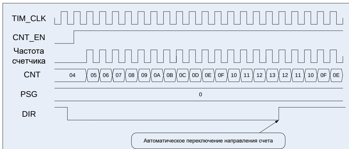
Рисунок 66 – Диаграммы работы таймера, счет двунаправленный, сначала прямой
