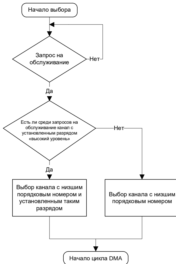
Рисунок 127 – Алгоритм выбора следующего канала для обслуживания
