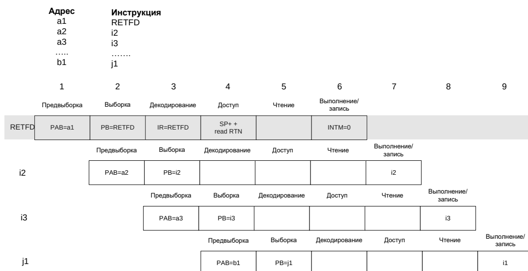
Рисунок 19–23 – Задержанная команда быстрого возврата в конвейере
