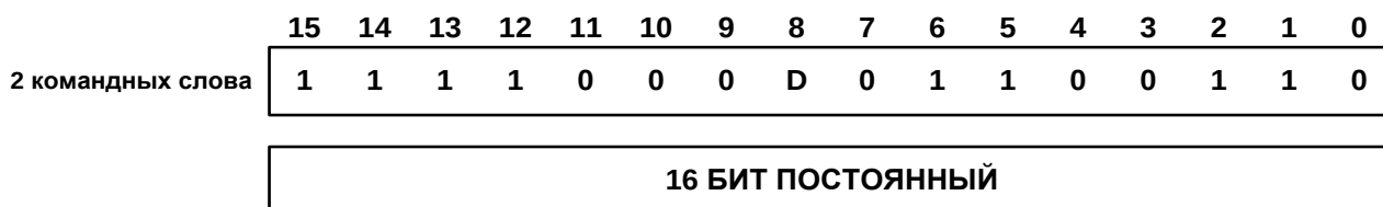
Рисунок 19–31 – Команда RPT с 16-разрядной непосредственной адресацией
