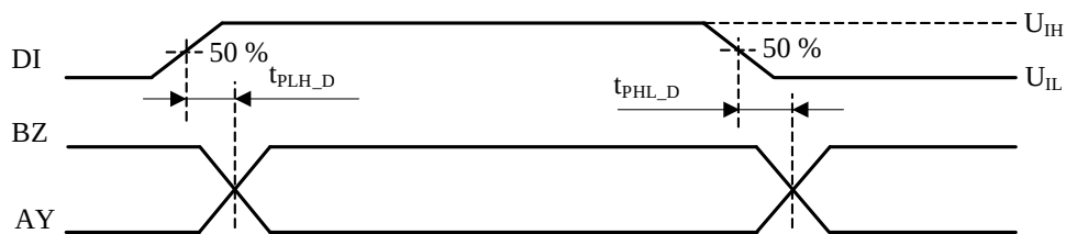
Рисунок 3 – Временная диаграмма при измерении t_{PLH\_D} и t_{PHL\_D}
