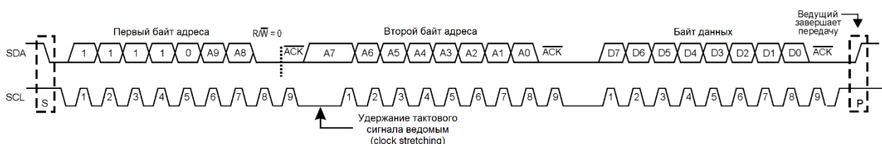
Рисунок 94 – Передача по I2C в 10-битном режиме
