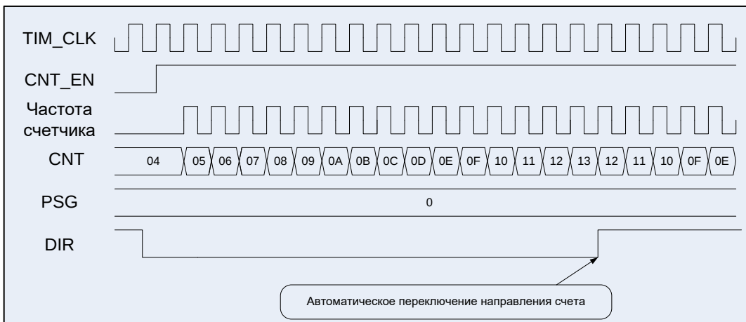
Рисунок 60 – Диаграммы работы таймера, счет двунаправленный, сначала прямой
