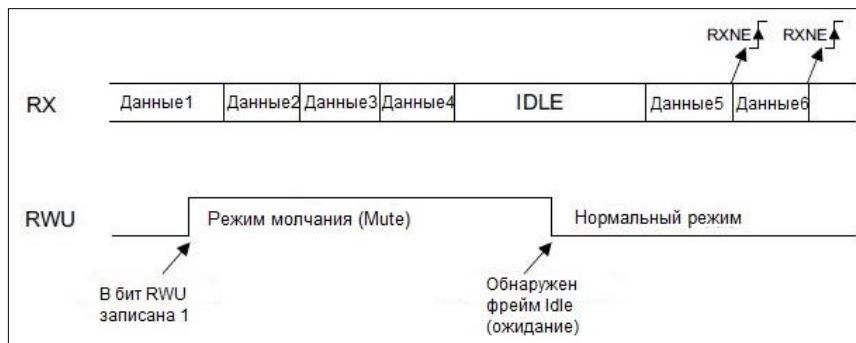
Рисунок 122 – Режим молчания (Mute) с обнаружением линии Idle
