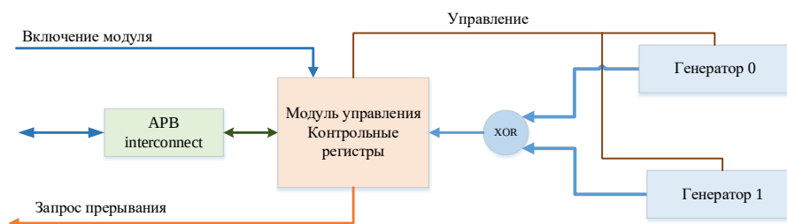
Рисунок 114 – Структурная схема блока генератора случайных чисел
