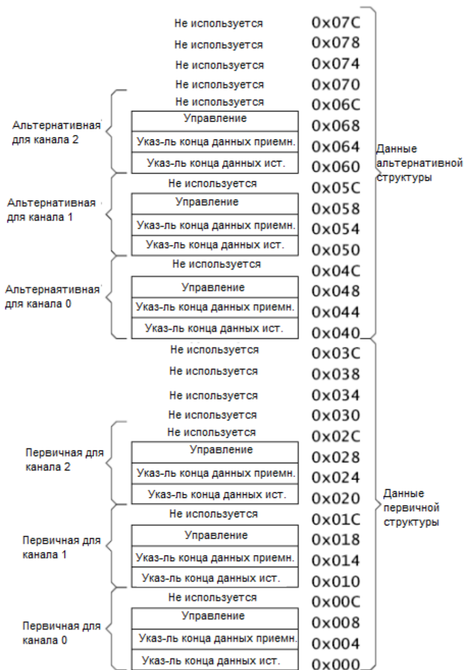
Рисунок 103 – Карта памяти для трех каналов ПДП, включая альтернативную структуру управляющих данных
