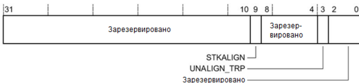
Рисунок 132 – Назначение разрядов регистра CCR
