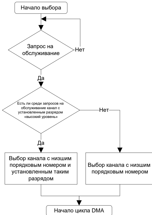
Рисунок 98 – Алгоритм выбора следующего канала для обслуживания
