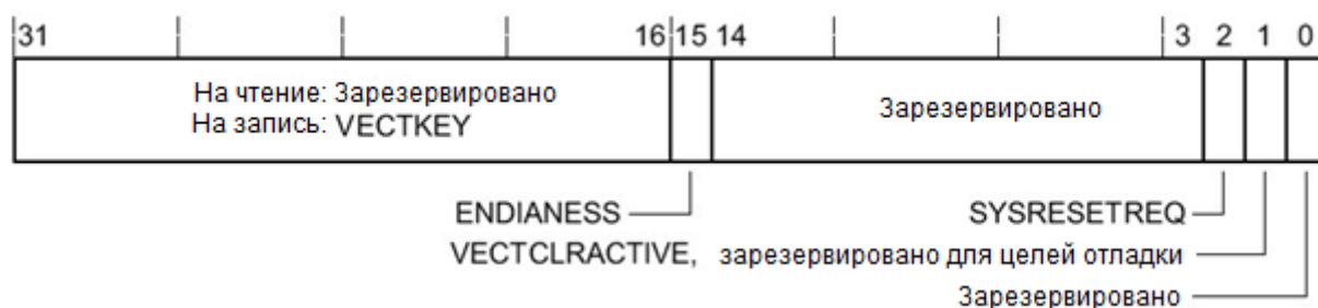
Рисунок 130 – Назначение разрядов регистра AIRCR
