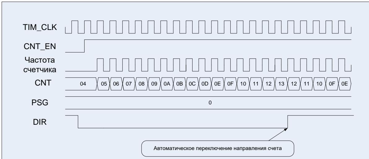
Рисунок 36 – Диаграммы работы таймера, счет вверх/вниз, сначала вверх
