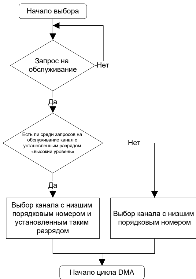
Рисунок 98 показывает процесс выбора следующего канала для обслуживания.
