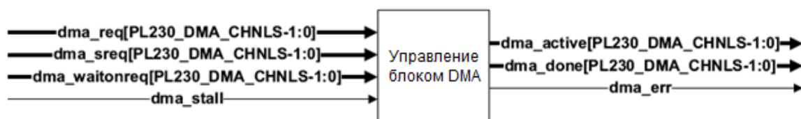
Рисунок 91 – Сигналы интерфейса управления ПДП
