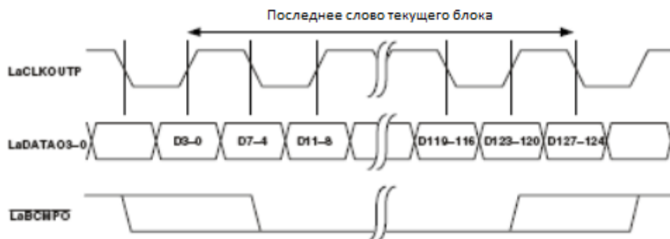
Рисунок 80 – Порт связи “а” передает порту связи “b” с завершением блока
