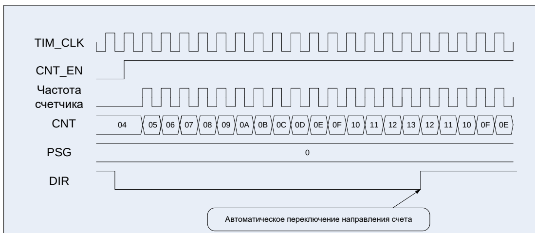
Рисунок 22 – Диаграммы работы таймера, счет вверх/вниз, сначала вверх
