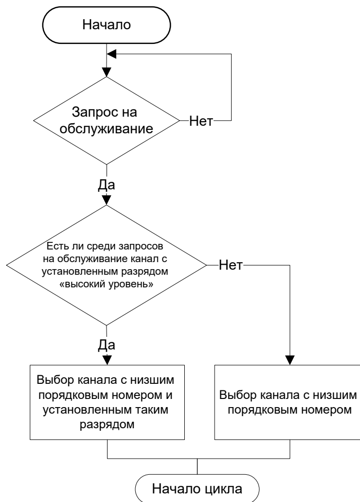
Рисунок 44 – Алгоритм выбора следующего канала для обслуживания
