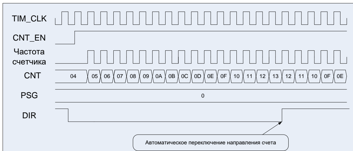
Рисунок 66 – Диаграммы работы таймера, счет двунаправленный, сначала прямой
