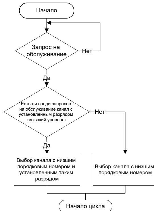
Рисунок 65 – Алгоритм выбора следующего канала для обслуживания
