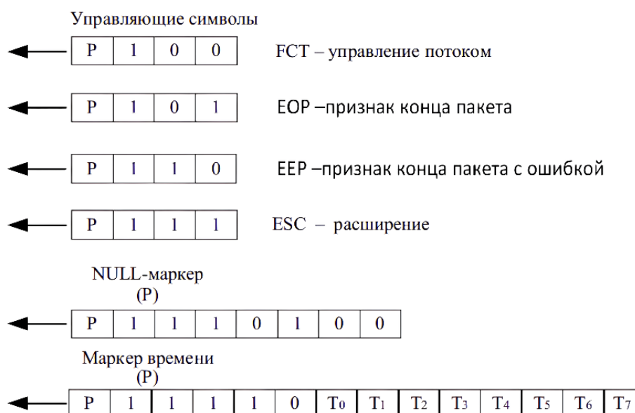
Рисунок 76 – Управляющие символы SpaceWire
