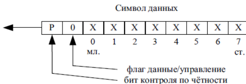
Рисунок 75 – Символ данных SpaceWire
