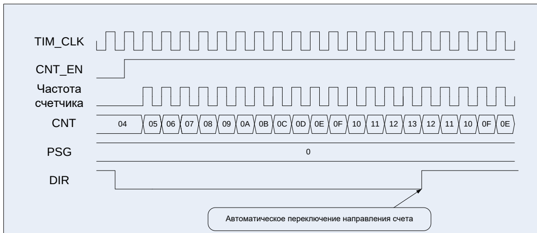
Рисунок 38 – Диаграммы работы таймера, счет двунаправленный, сначала прямой
